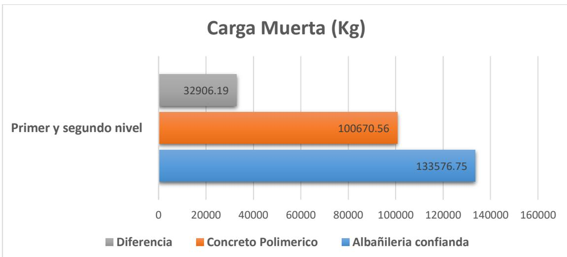
**Figura 26. Comparación de Carga Muerta (Kg) SAP2000**
