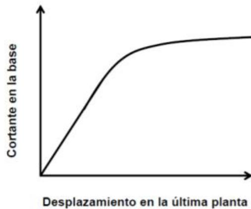
*Figura 8:* Desplazamiento con relación a la cortante basal.
