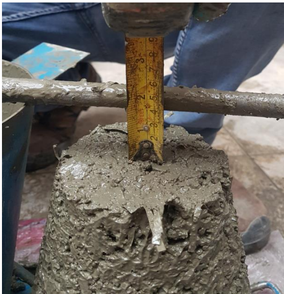
Concreto con 800 gr/m 3 de fibra de rafia Slump: 1 ½"
