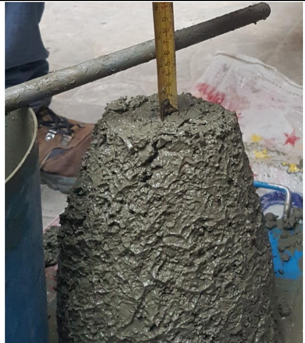
Concreto con 600 gr/m 3 de fibra de rafia Slump: 2 ¼"
