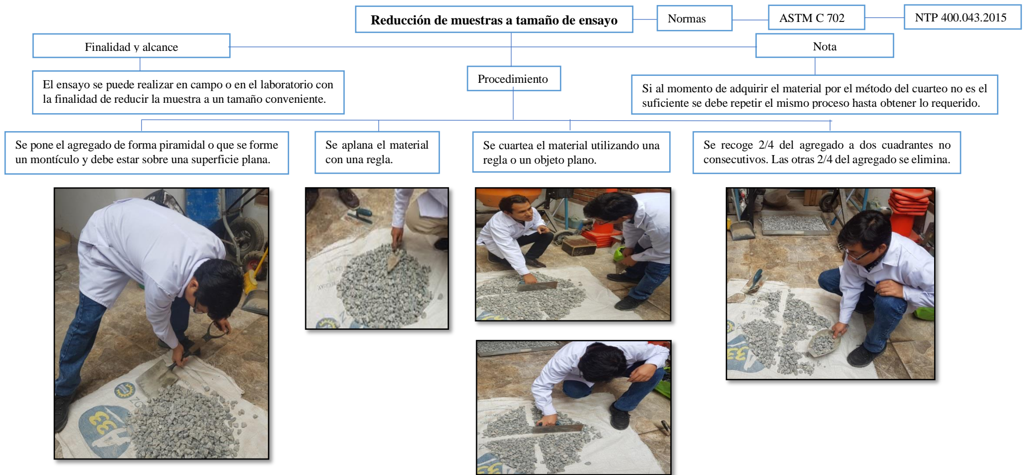
Figura 45. Reducción de muestras a tamaño de ensayo
