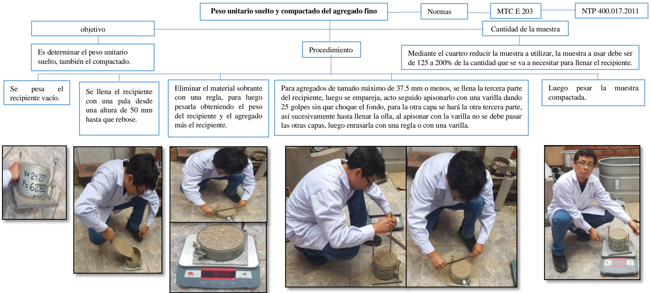
Figura 51. Peso unitario suelto de agregado fino
