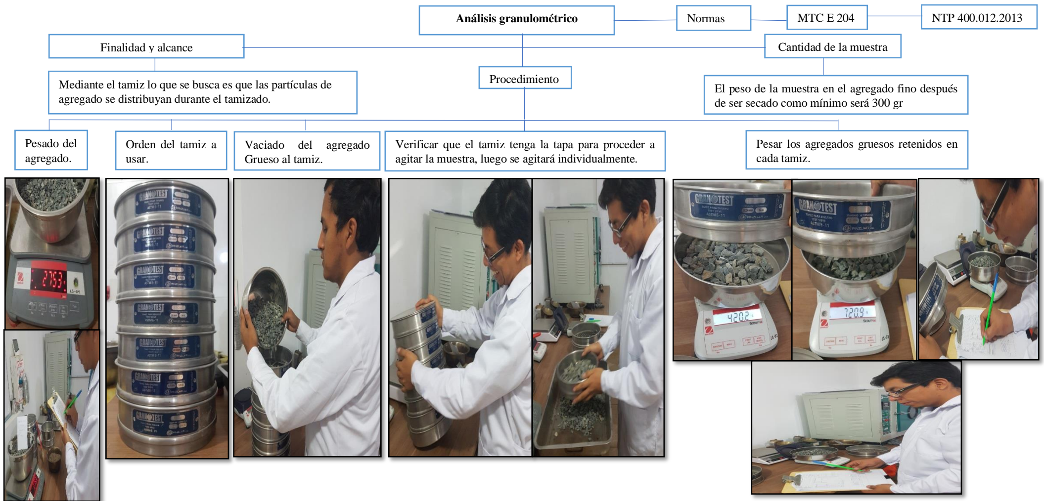
Figura 47. Análisis granulométricos de agregado Grueso
