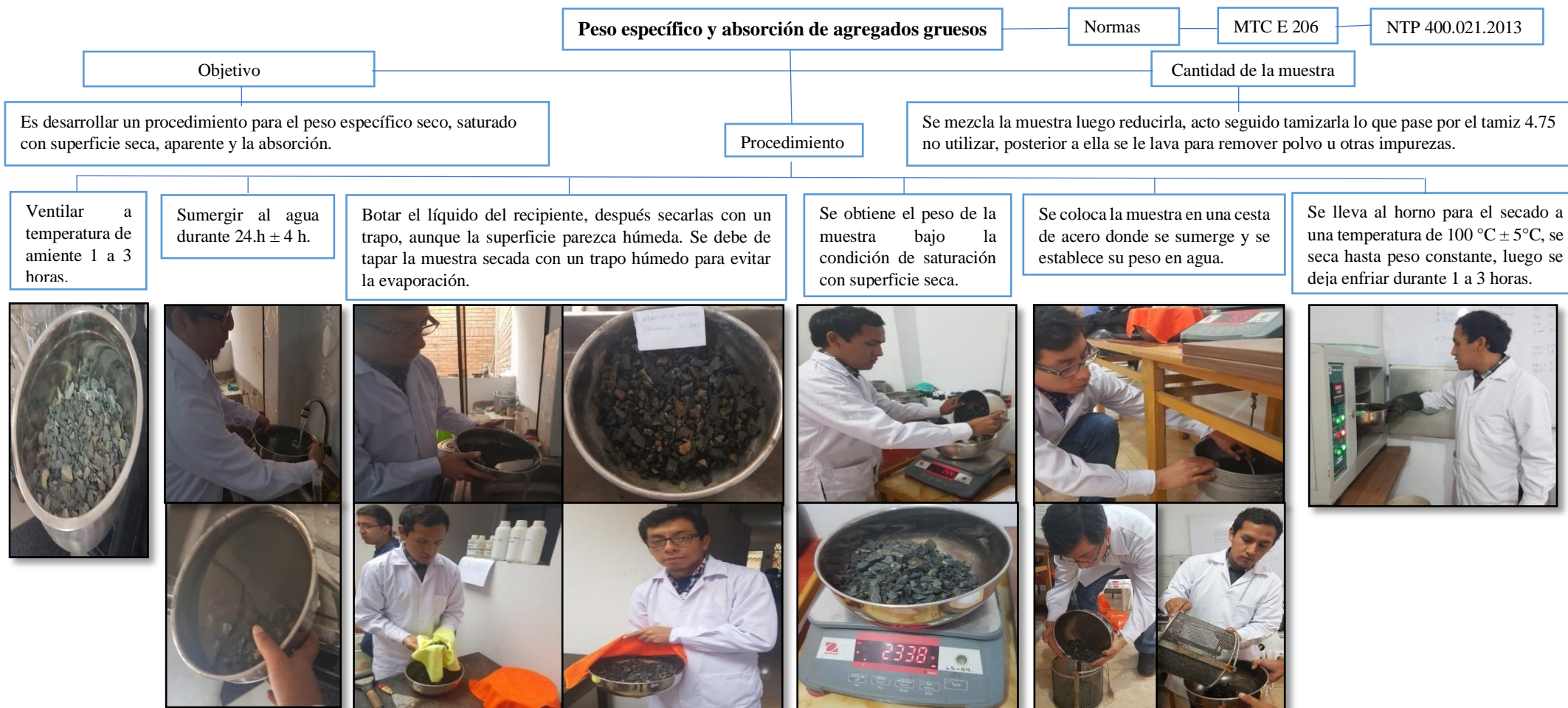
Figura 49. Peso específico y absorción de agregados gruesos
