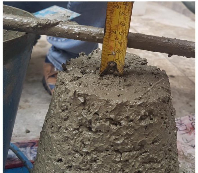
Concreto con 1000 gr/m 3 de fibra de rafia Slump: 1 ¼"
