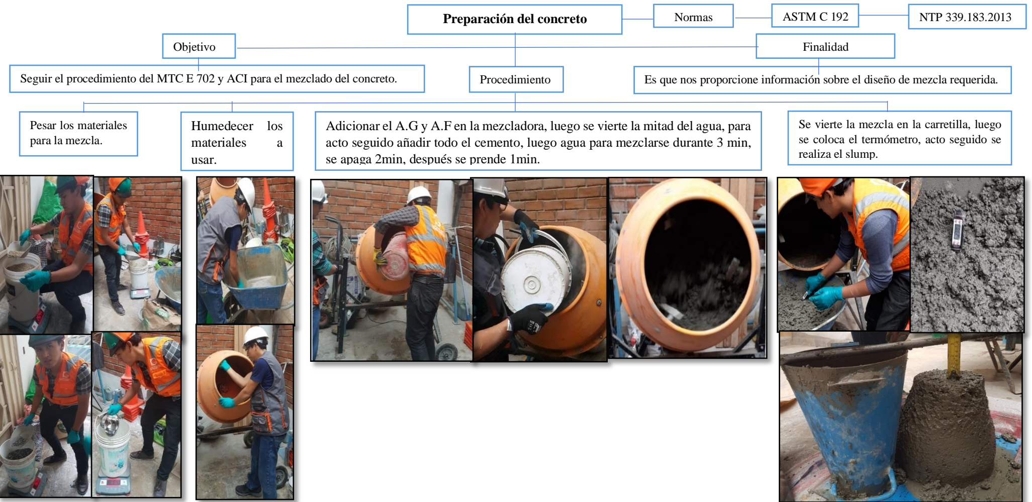
Figura 66. Preparación del concreto Fuente: Elaboración propia
