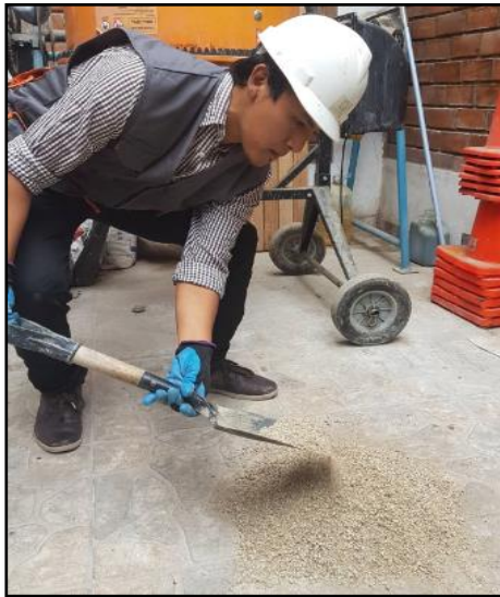
Figura 46. Reducción de muestras a tamaño de ensayo
