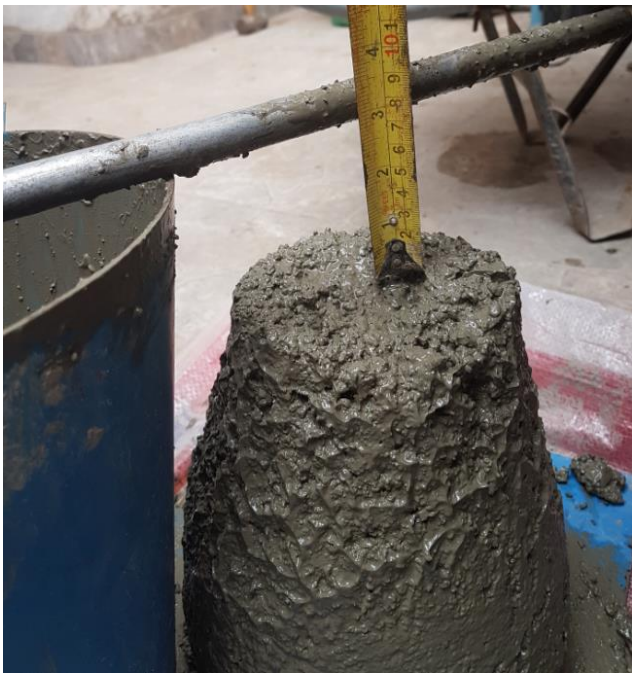
Concreto Patrón Slump: 3"
