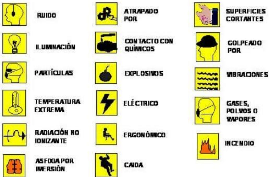
Figure 12. Señales de Seguridad.
