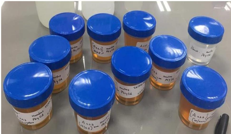
**Figura 25:** Proceso de bioadsorción para determinar el tiempo de equilibrio.
