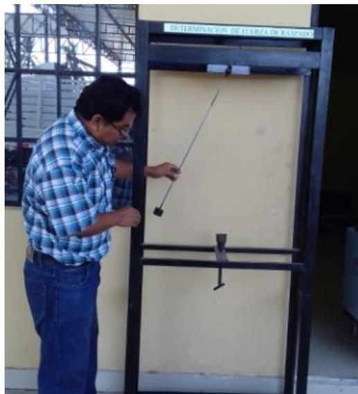
3. Una vez asegurado el limón en la copa se procede a levantar la pesa con superficie rascadora hasta que haga un ángulo inicial de  $10^\circ$  con respecto a la horizontal, se suelta la pesa y se verifica, si provoca o no un raspado en la superficie del limón. Si no provoca ningún efecto o se quedara estancada la pesa, se procede a repetir la prueba incrementando el ángulo inicial en  $10^\circ$ .
