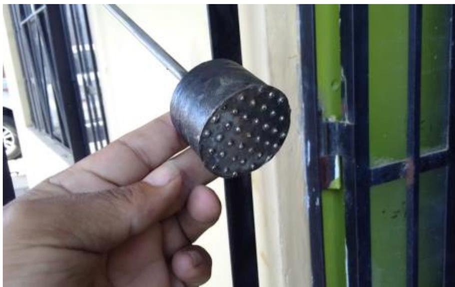
**Figura 43.** Detalle de pesa con superficie raspadora para la determinación de fuerza de raspado
