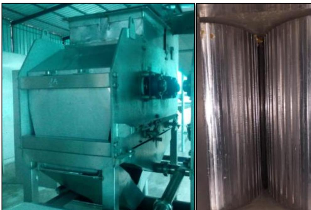
**Figura 14.** Máquina extractora de jugo de limón tipo polycitrus y detalle de rodillos estrujadores de la máquina. Cortesía de Agromar Industrial S.A.
