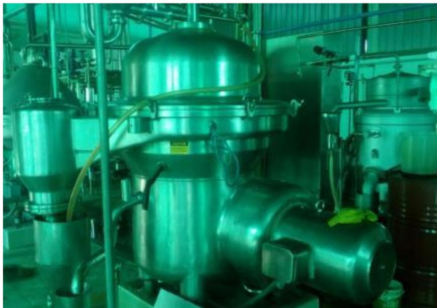
**Figura 48.** Centrifuga primaria o deslodadora
