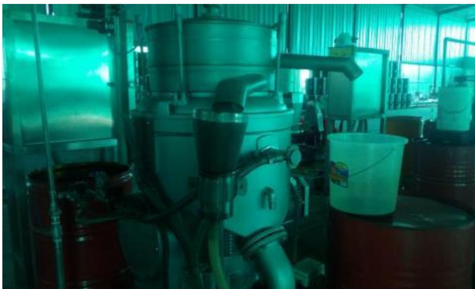
**Figura 49.** Centrífuga secundaria o pulidora
