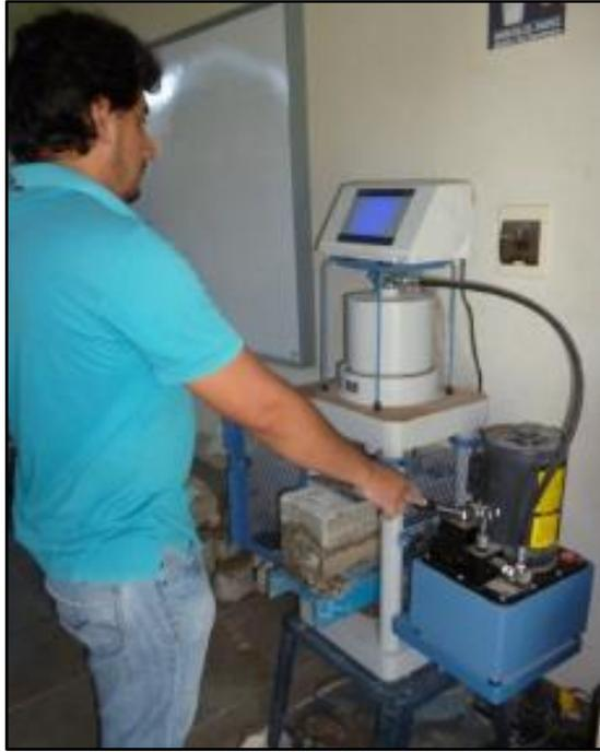
Realización del Ensayo a Flexión
