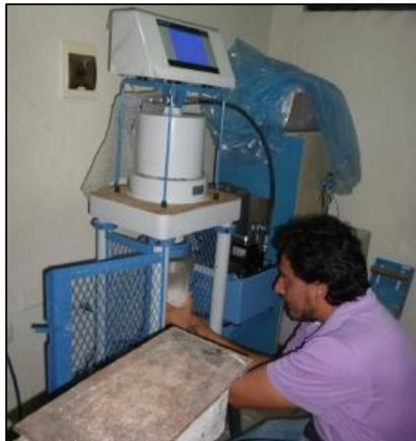
Realización del Ensayo a Compresión
