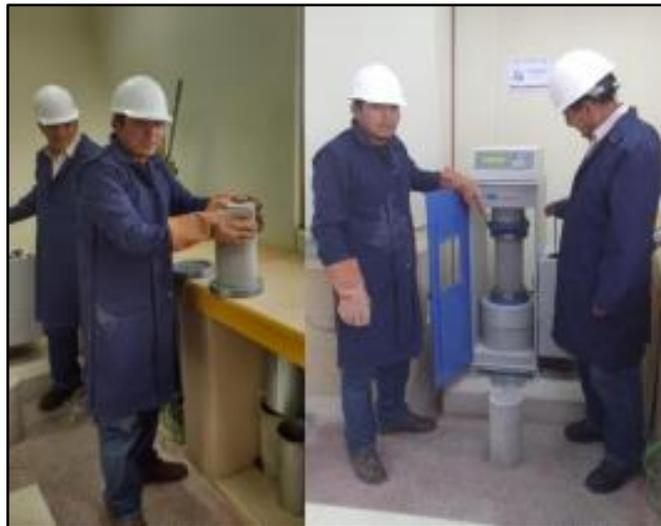
*Figura. Realización del ensayo de Compresión*
