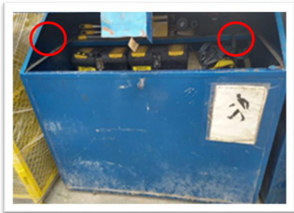
Figura N°3: Condición Subestandar – Caja de herramientas sin pistones de seguridad.
