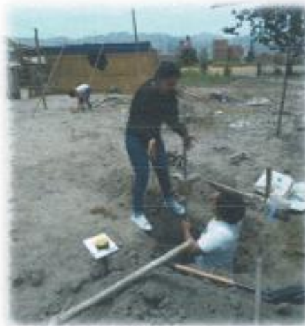
En la imagen se aprecia el comienzo de las excavaciones de las calicatas y los ensayos de DPL.
