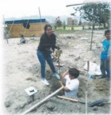
En la imagen se aprecia el comienzo de las excavaciones de las calicatas y los ensayos de DPL.
