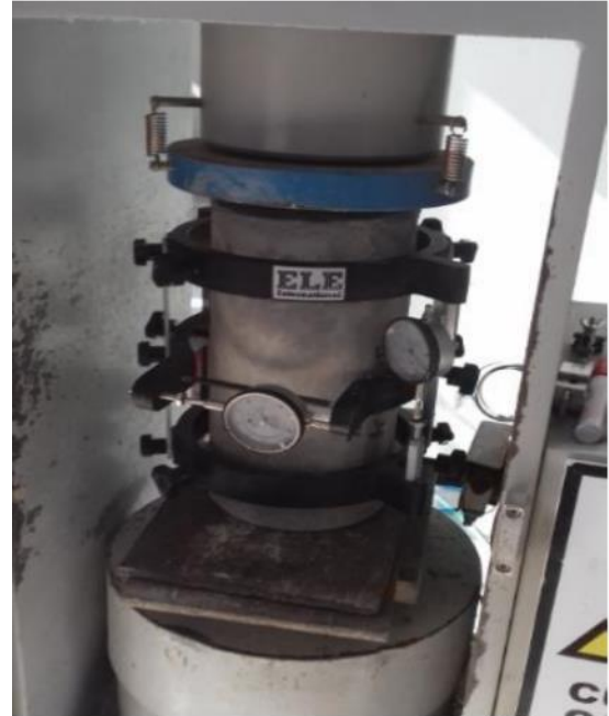
Imagen 14. Ensayo del método estándar para módulo estático de la relación de Poisson y la elasticidad del concreto en compresión a los 28 días de edad, realizado en la máquina de compresión axial.
