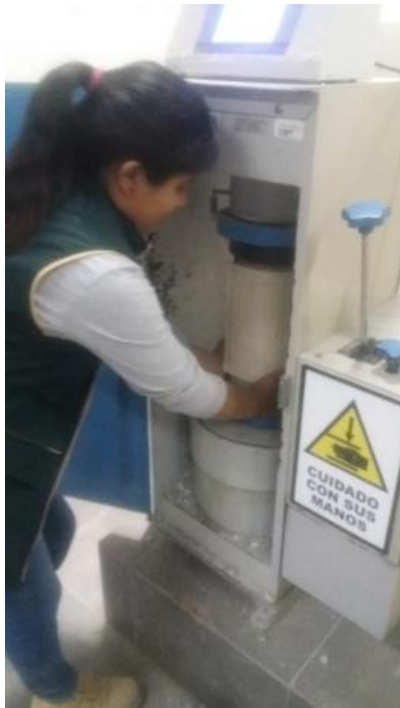
Imagen 3. Ensayo de la Resistencia a la compresión del concreto.
