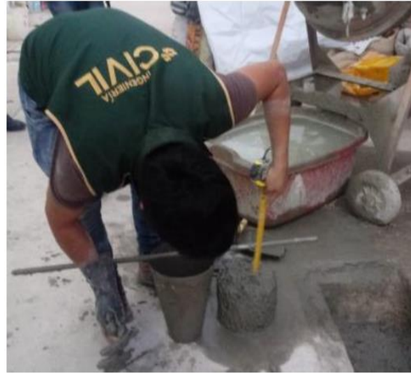
Imagen 10. Ensayo de Asentamiento del concreto con el cono de Abrams.
