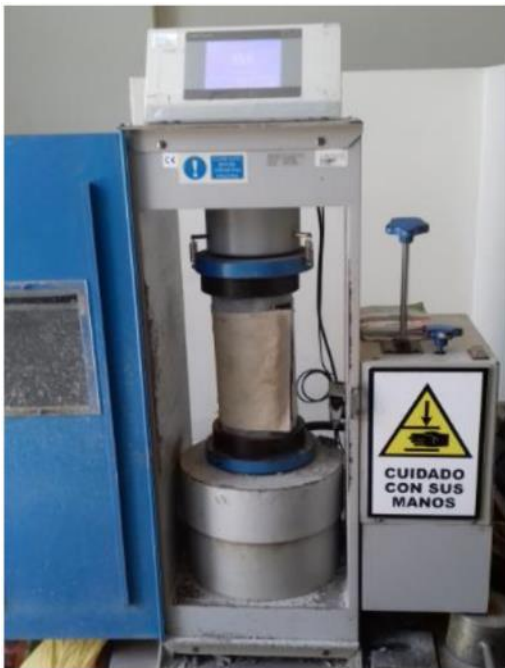
Imagen 11. Ensayo normalizado para determinación de la resistencia a la compresión del concreto en diferentes edades, realizado en la máquina de compresión axial.
