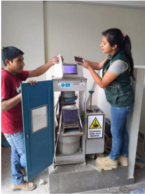
Imagen 5. Ensayo de la Resistencia a la flexión del concreto.
