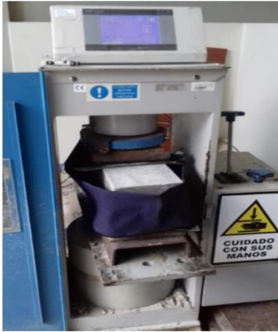
Imagen 13. Ensayo normalizado para determinación de la resistencia a la flexión del concreto a los 28 días edad, realizado en la máquina de compresión axial.
