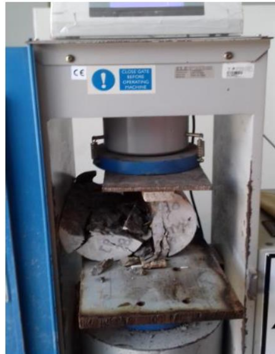
Imagen 12. Ensayo normalizado para determinación de la resistencia a la tracción del concreto a los 28 días de edad, realizado en la máquina de compresión axial.
