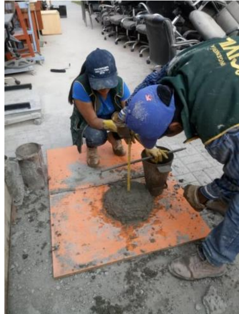
Imagen 2. Verificación del Asentamiento del concreto.
