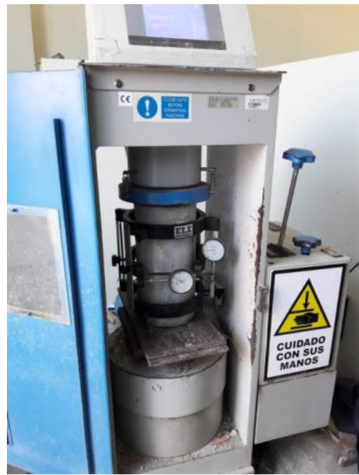
Imagen 6. Ensayo de Módulo de elasticidad del concreto.
