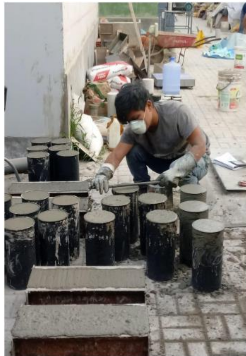
Imagen 8. Llenado de probetas y vigas de concreto.
