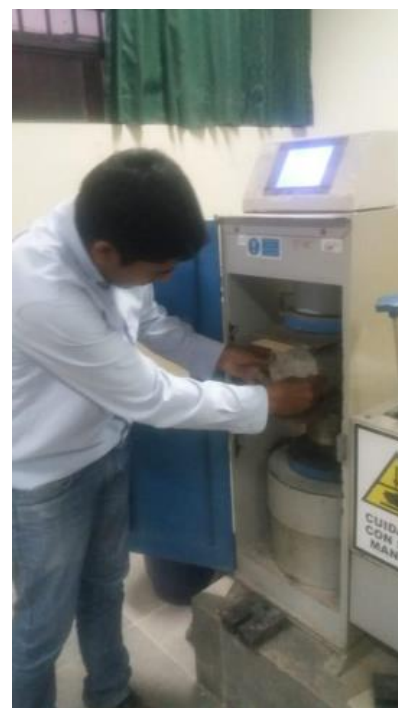
Imagen 4. Ensayo de la Resistencia a la tracción del concreto.
