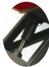
Mecanismo de regulación de altura de la mesa, permitirá evitar que se trabaje por sobre el hombro y se adapten Posturas dentro de los límites de confort.
