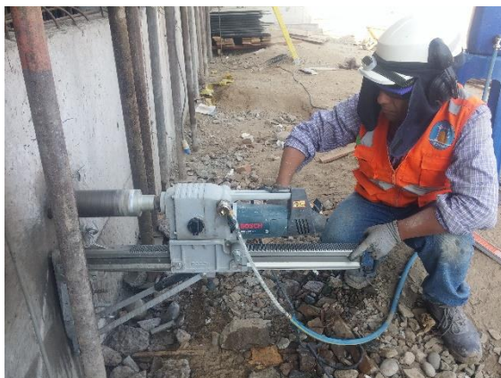
Figura 01: Prueba de diamantina.
