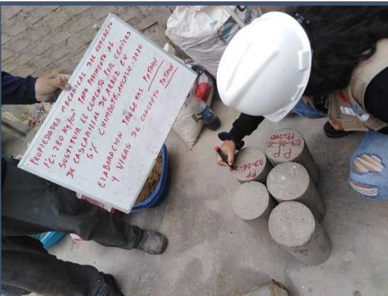
Imagen N° 12: Probetas F'c=280 \text{ Kg/cm}^2 (Patrón)
