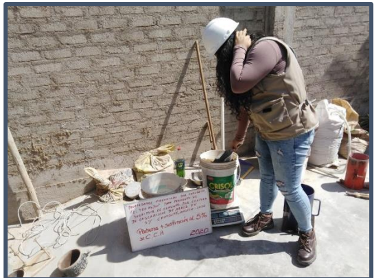
Imagen N° 17: Pesaje de agregados para mezcla experimental
