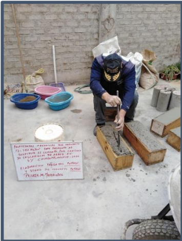
Imagen N° 13: Realización de vigas F'c=280 \text{ Kg/cm}^2 (Patrón)
