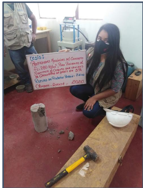
Imagen N° 32: Rotura de probetas patrón
