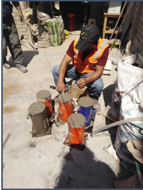
Imagen N° 23: Realización de probetas de concreto experimental – sustitución 5% CCA.
