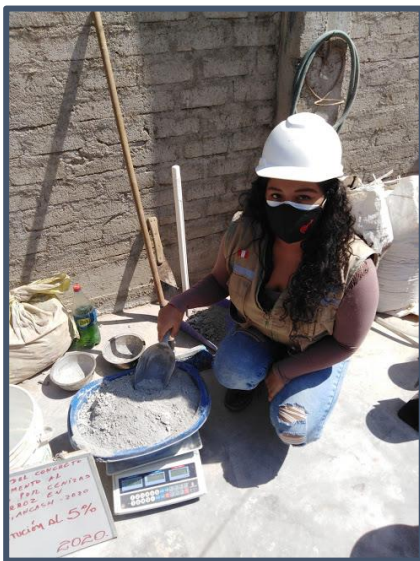
Imagen N° 18: Pesaje de cemento para mezcla experimental
