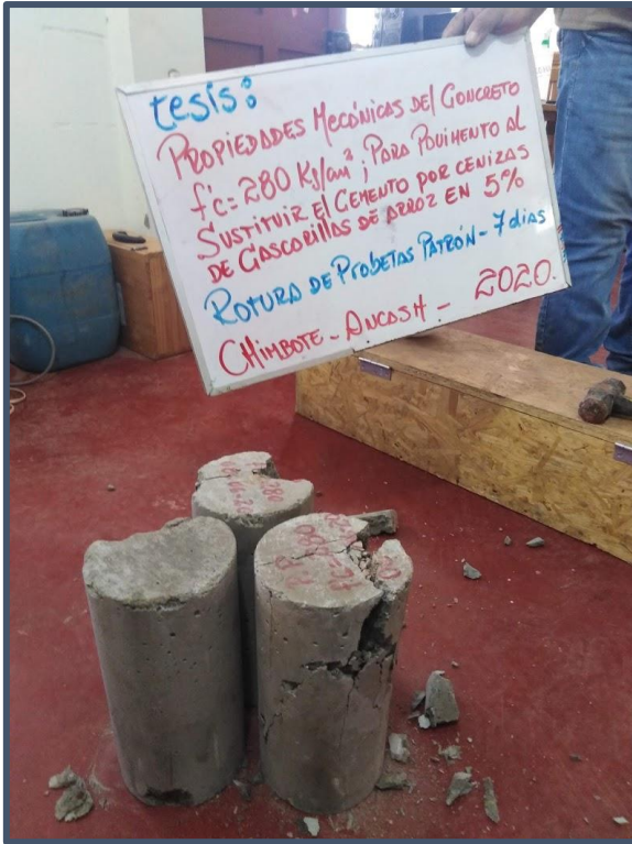
Imagen N° 33: Rotura de probetas patrón
