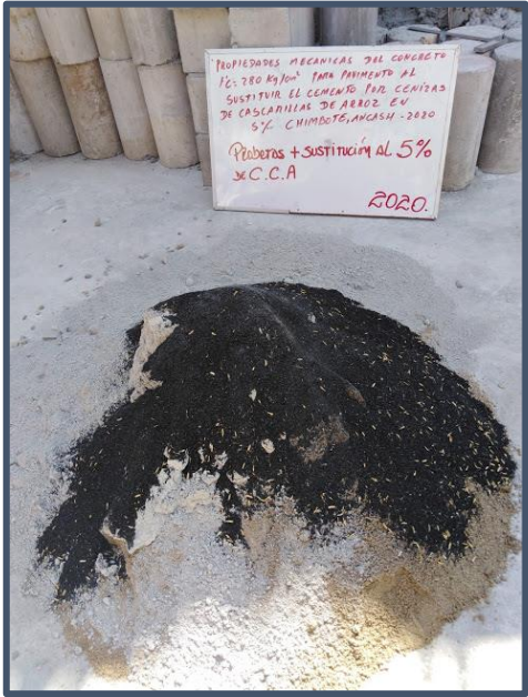
Imagen N° 21: Materiales para mezcla experimental – sustitución de cemento por cenizas de cascarilla de arroz en 5%
