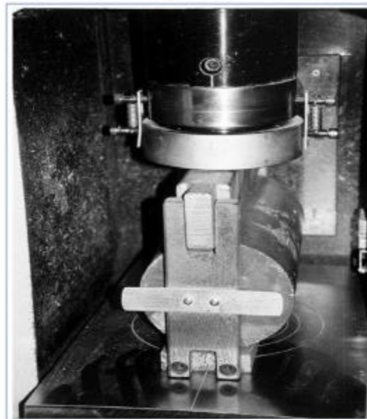
Figura 3. Cilindro colocado para ensayo de tensión indirecta
