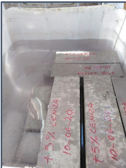
Imagen N° 30: Probetas y vigas de concreto experimental cumpliendo sus edades de curado
