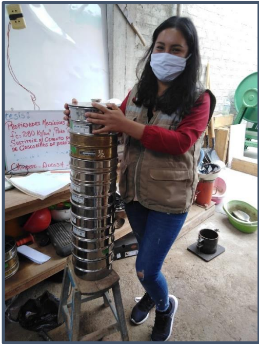
Imagen N° 06: Granulometría del agregado grueso
