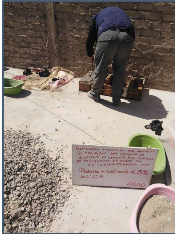
Imagen N° 25: Realización de vigas de concreto experimental – sustitución 5% CCA.
