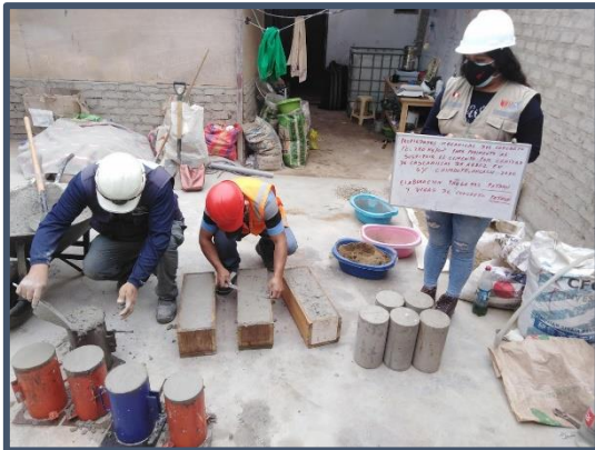
Imagen N° 16: Realización de vigas F'c=280 Kg/cm 2 (Patrón)
