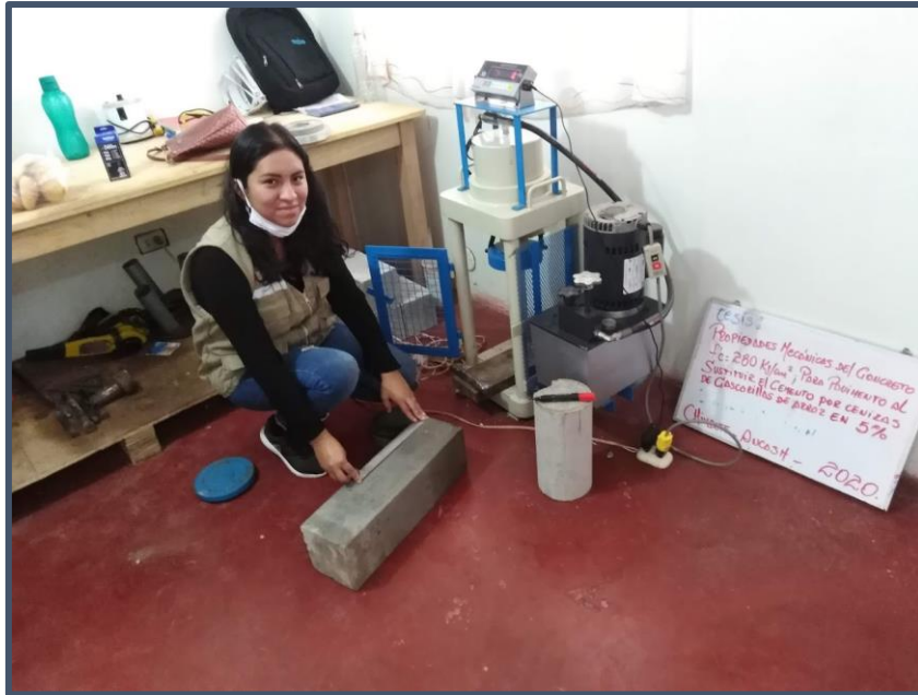
Imagen N° 35: Medidas de vigas de concreto para posterior rotura
