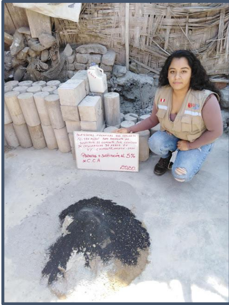
Imagen N° 20: Materiales para mezcla experimental – sustitución de cemento por cenizas de cascarilla de arroz en 5%
