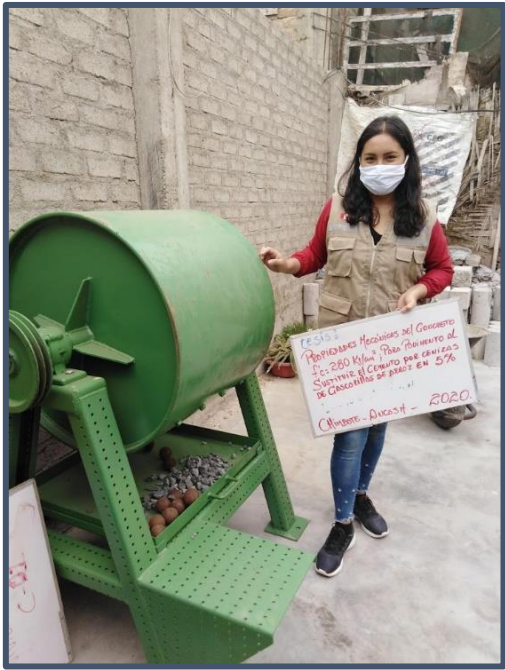
Imagen N° 07: Ensayo de abrasión de los ángeles
