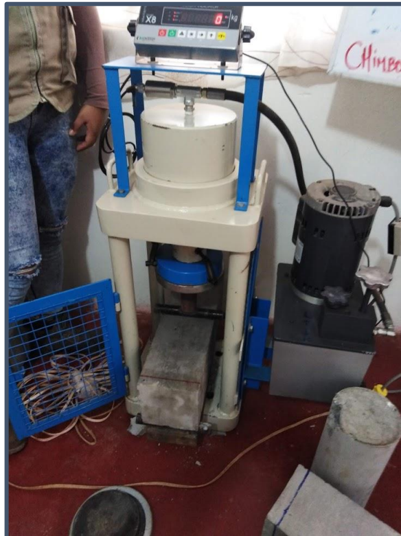
Imagen N° 36: Rotura de vigas de concreto
