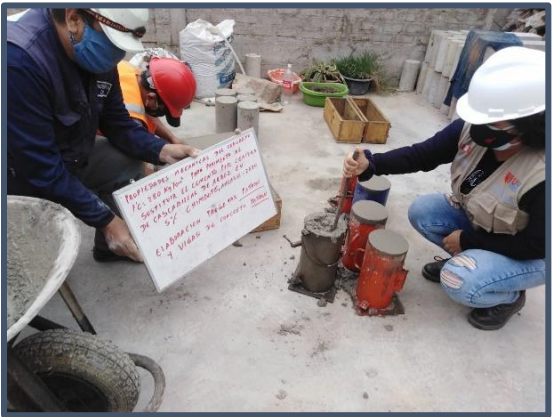
Imagen N° 11: Realización de probetas F'c=280 \text{ Kg/cm}^2 (Patrón)
