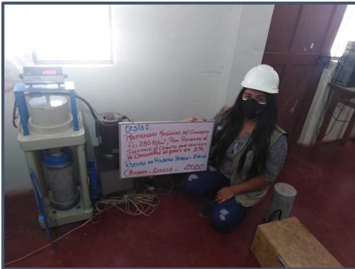
Imagen N° 31: Rotura de probetas patrón
