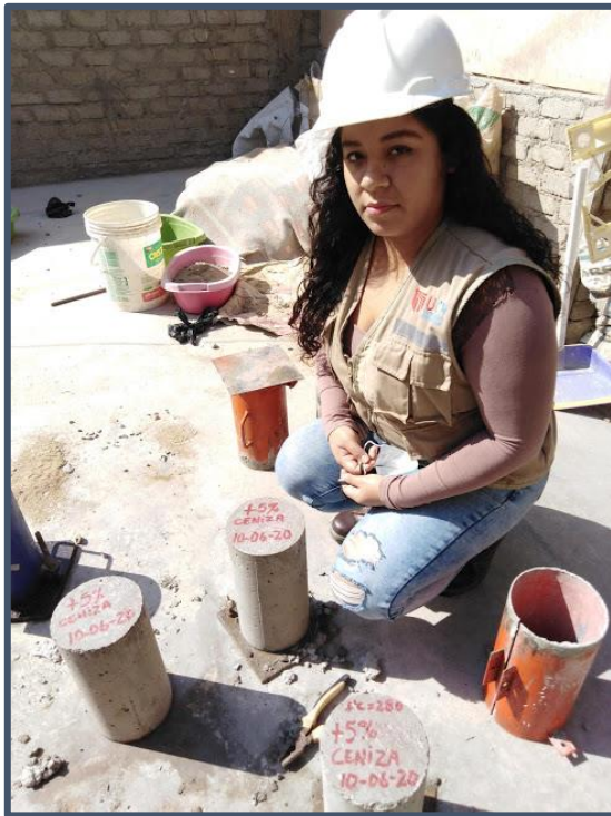
Imagen N° 26: Desencofrado de probetas de concreto experimental – sustitución 5% CCA.
