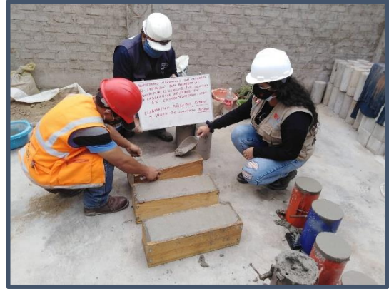
Imagen N° 15: Realización de vigas F'c=280 Kg/cm 2 (Patrón)
