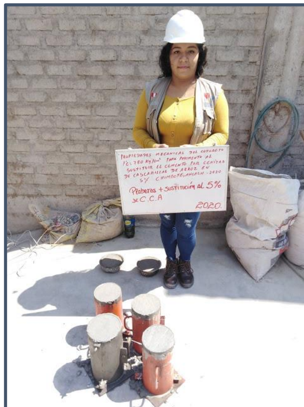
Imagen N° 25: Probetas de concreto experimental – sustitución 5% CCA.
