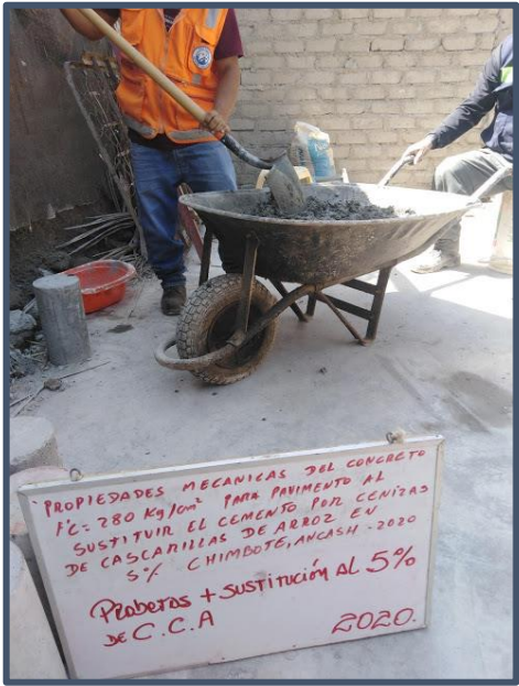
Imagen N° 22: Mezcla experimental – sustitución de cemento por cenizas de cascarilla de arroz en 5%
