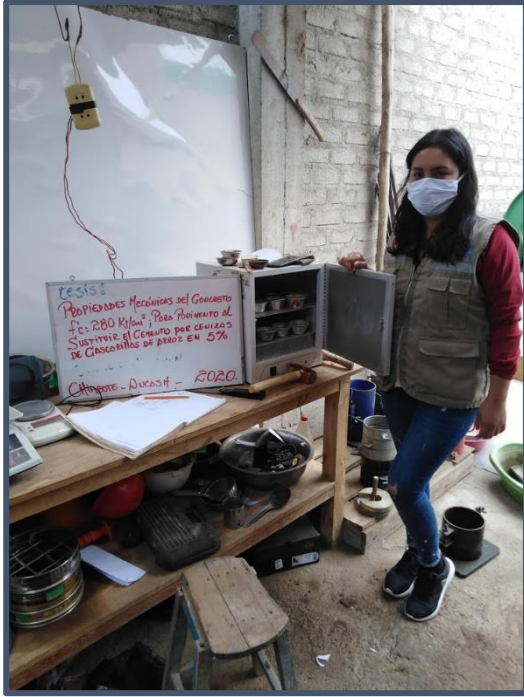
Imagen N° 04: Determinación de contenido de humedad de agregados
