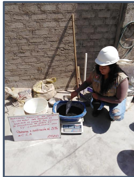
Imagen N° 19: Pesaje de ceniza de cascarilla de arroz para mezcla experimental
