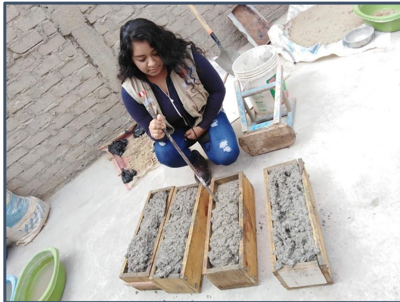
Imagen N° 24: Realización de vigas de concreto experimental – sustitución 5% CCA.
