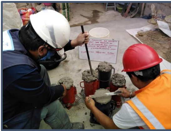
Imagen N° 10: Realización de probetas F'c=280 \text{ Kg/cm}^2 (Patrón)
