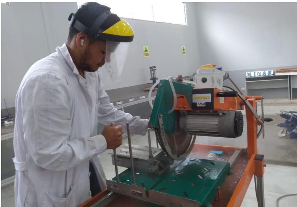
*Fotografía 12: Corte de los testigos para el ensayo a compresión simple*
