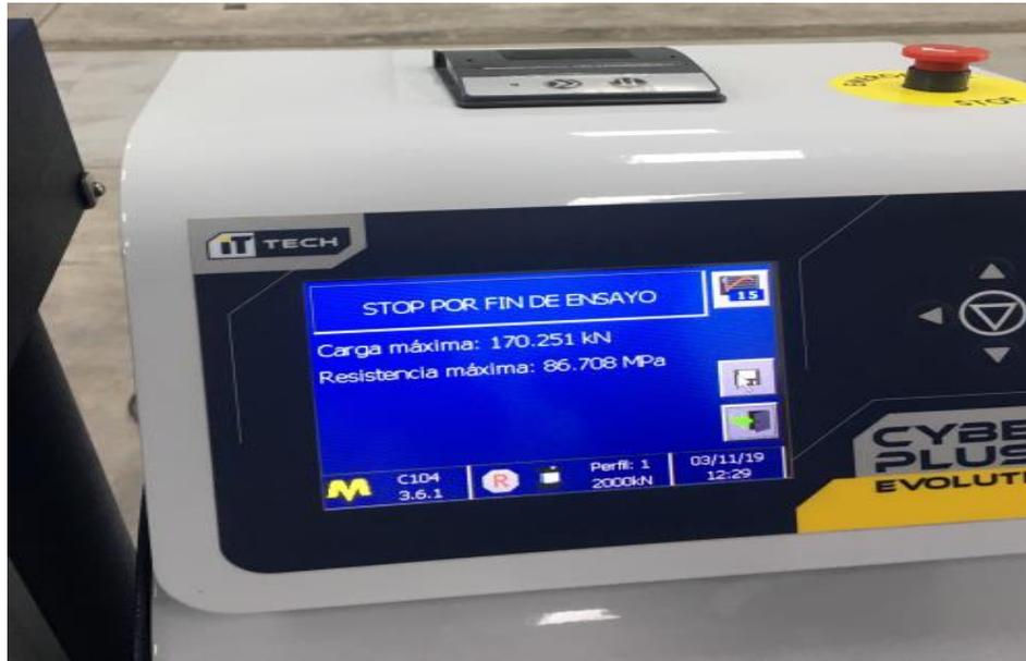
*Fotografía 15: Resultado del ensayo a compresión simple*
