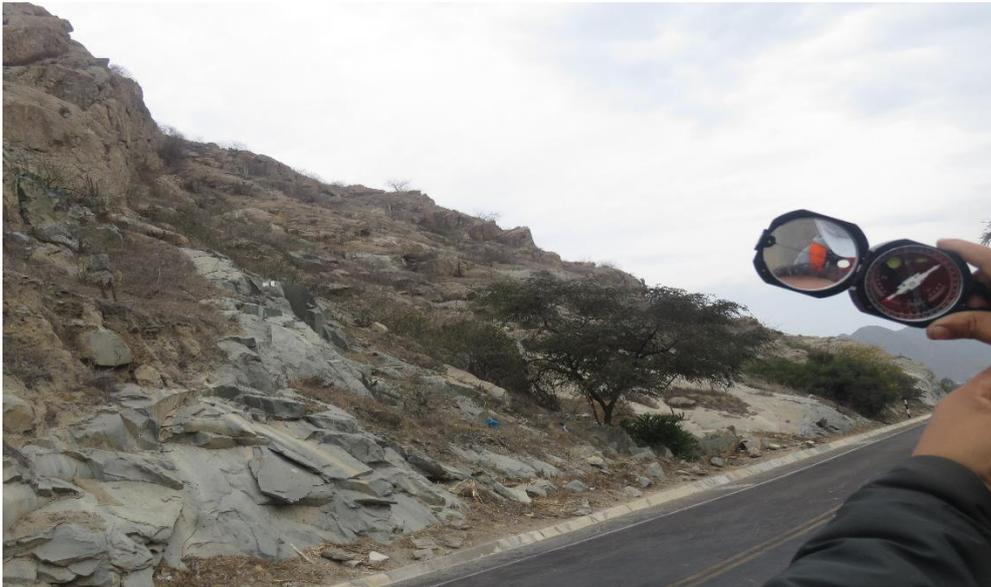
*Fotografía 5: Orientación del talud*
