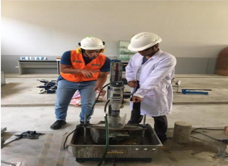
*Fotografía 11: Perforación de los testigos*
