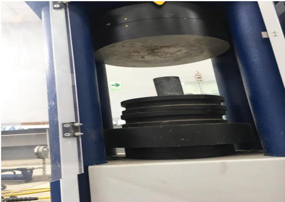
*Fotografía 14: Ensayo a compresión simple*
