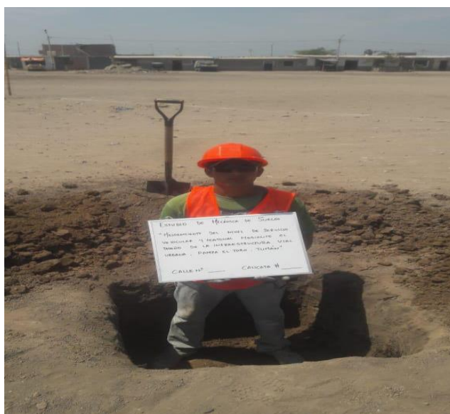
Figura 16: Excavación de calicatas en Sector Pampa El Toro.
