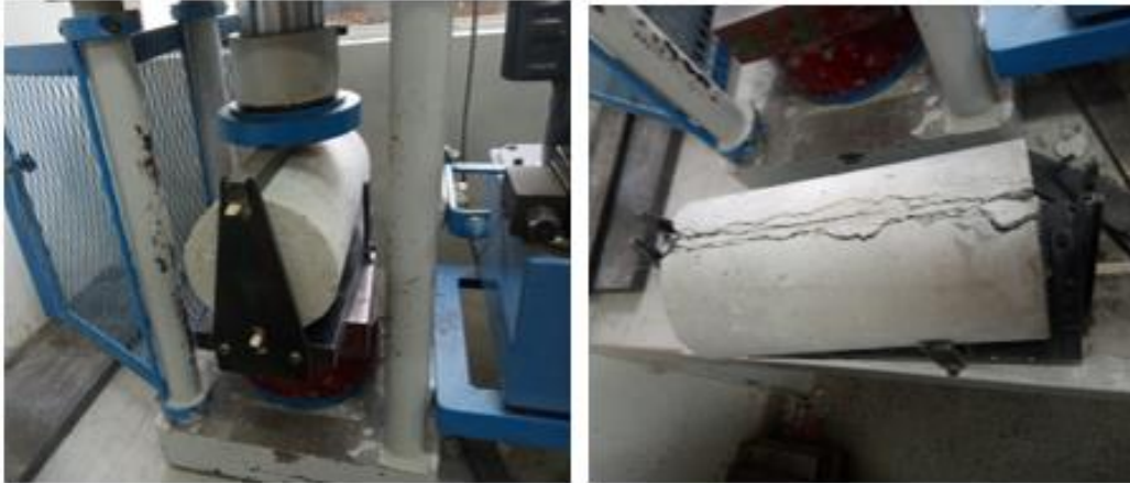
Figura 14: Ensayo de resistencia a la tracción por compresión diametral de muestra sin incorporación de residuos de alambre (1.50%).
