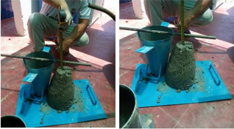
Figura 1: Comparación de Slump de un concreto dosificado con residuos de alambre al 1.5% (izquierda) y otro sin dosificación de fibras de acero (derecha).
