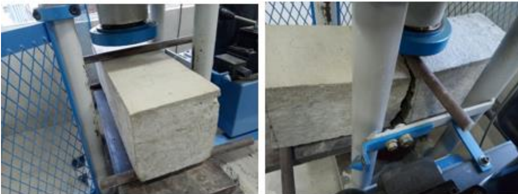
Figura 11: Ensayo de resistencia a la flexión muestra sin incorporación de residuos de alambre
