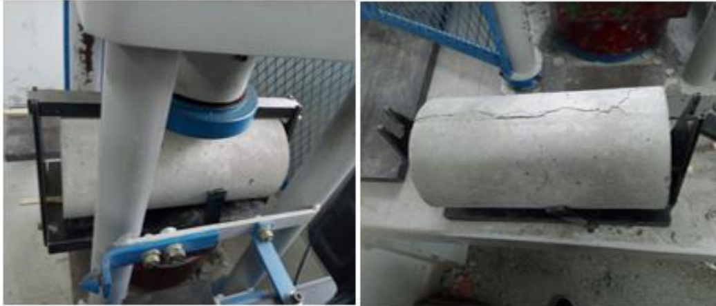
Figura 15: Ensayo de resistencia a la tracción por compresión diametral de muestra con incorporación de residuos de alambre (1.50%).
