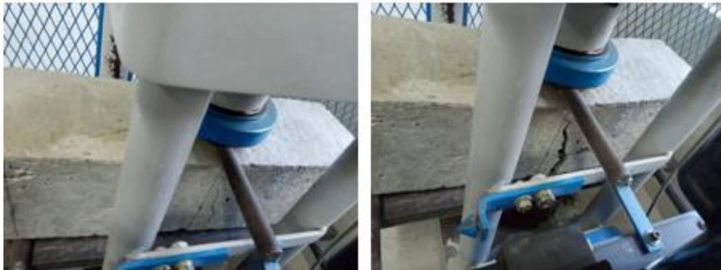
Figura 12: Ensayo de resistencia a la flexión muestra con incorporación de residuos de alambre (1.50%).
