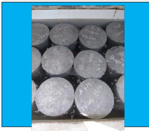
Curado de las probetas
