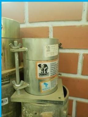
Molde para PUS Y PUV del agregado
