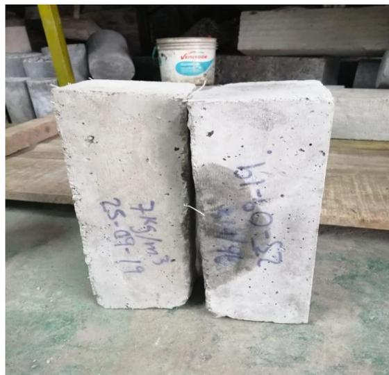
Figura 29. Vigas con macro-fibras sintéticas (7kg/m3)
