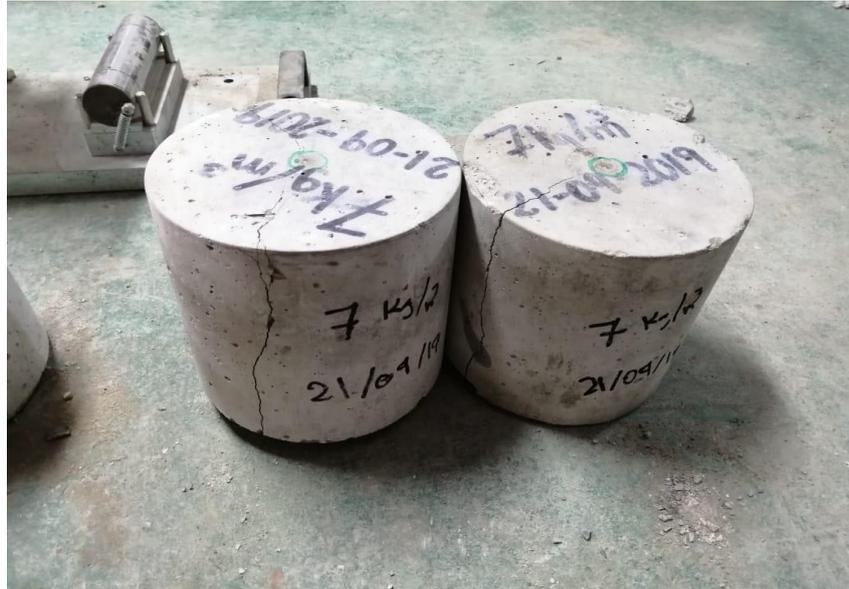
Figura 60. Probetas ensayadas con macro-fibras sintéticas (7kg/m<sup>3</sup>)
