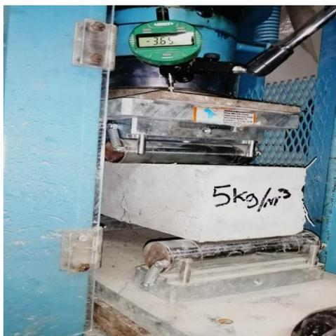
Figura 46. Ensayo a flexión de Vigas con macro-fibras sintéticas (5kg/m<sup>3</sup>)
