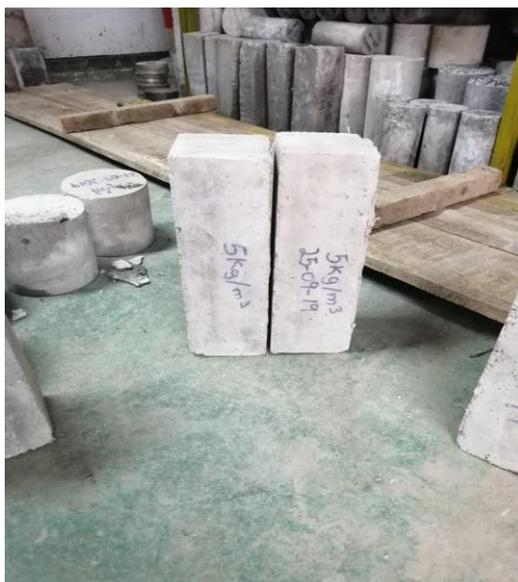
Figura 26. Vigas con macro-fibras sintéticas (5kg/m3)
