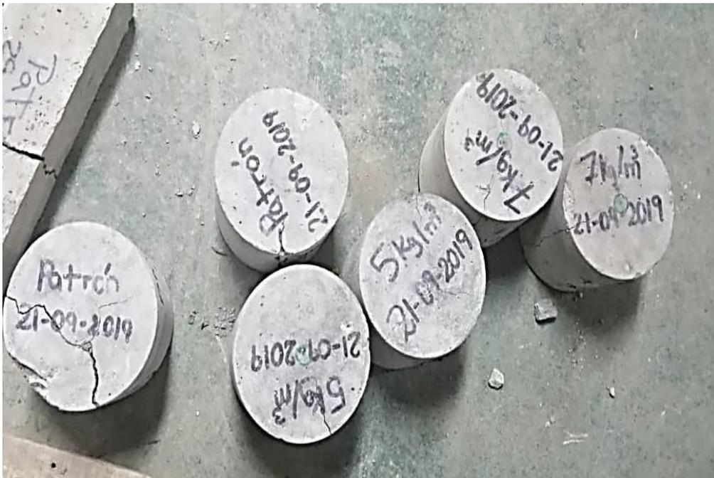
Figura 77. Probetas ensayadas, evidencia de fisuras.
