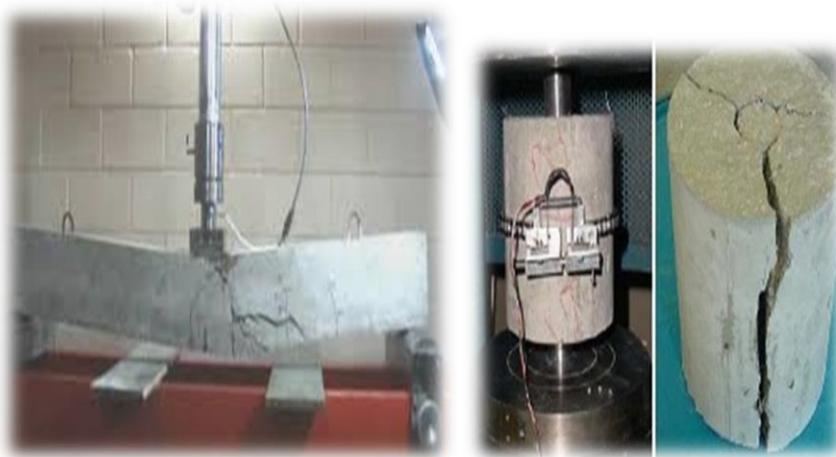
*Figura 13.* Muestras a ensayo a flexión y muestras a ensayo de doble punzonamiento
