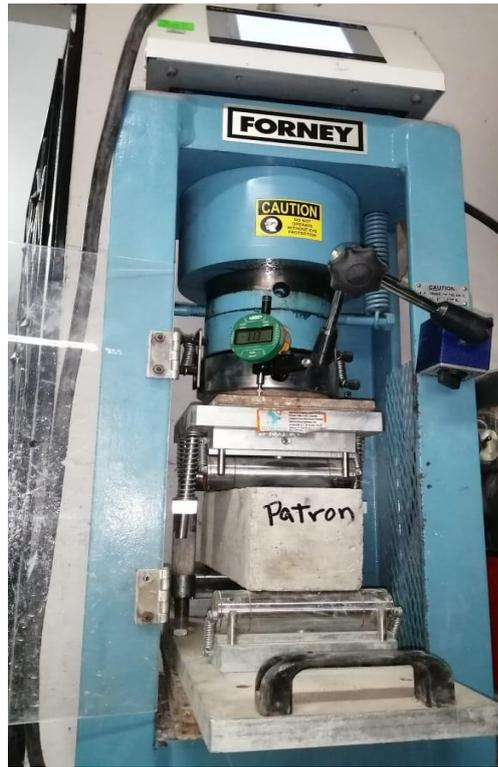
*Figura 43.* Ensayo a flexión Vigas concreto patrón
