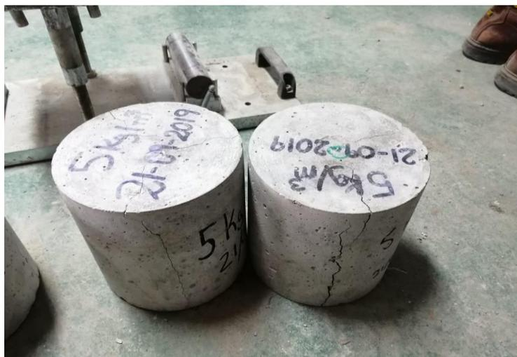
Figura 57. Probetas ensayadas con macro-fibras sintéticas (5kg/m<sup>3</sup>)
