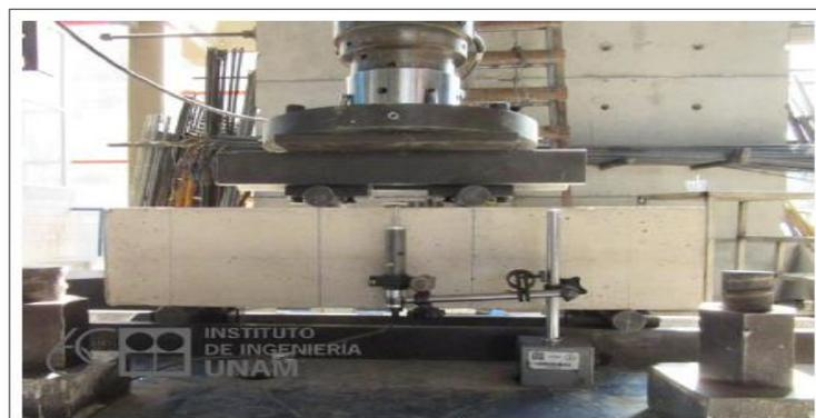
*Figura 4.* Ensayo a flexión en vigas
