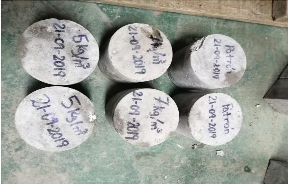
Figura 76. Probetas para el ensayo de doble punzonamiento.
