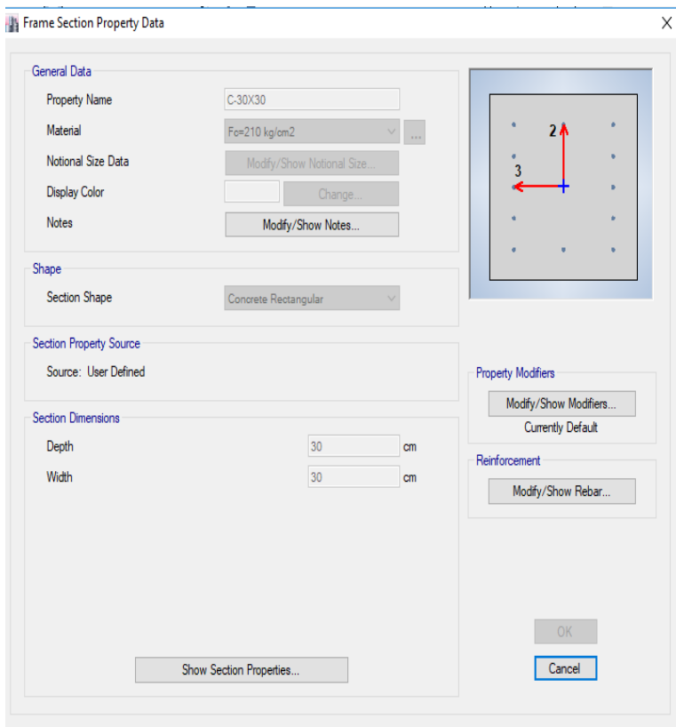
Figura 27: Definición De columnas (30X30) (ETABS 2016)
