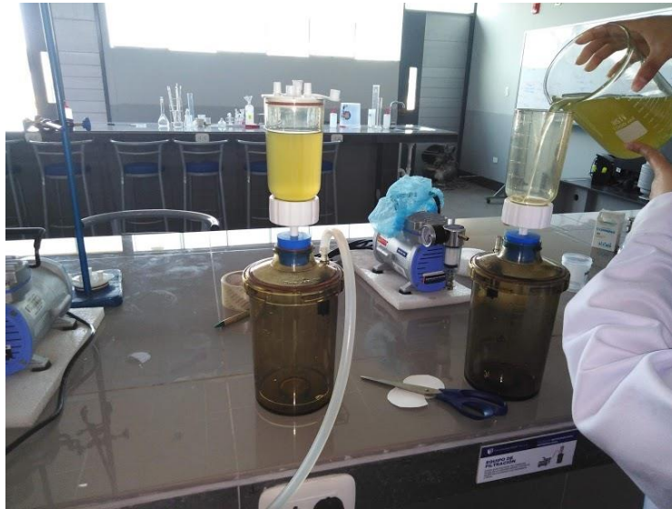
Filtración del agua del dren después de la prueba de jarras.
