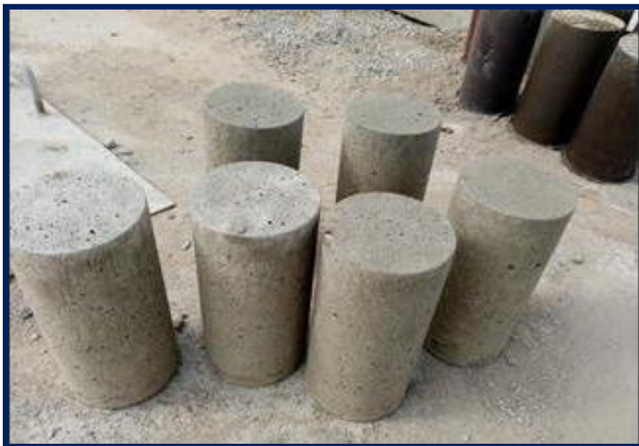
Figura 10: Desencofrado de especímenes
