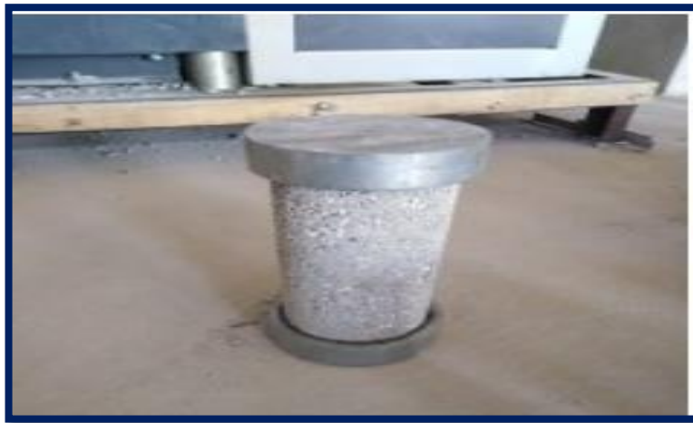
Figura 11: Colocación de anillos para rotura a la compresión de especímenes
