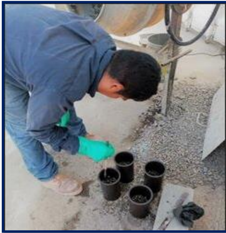
Figura 9: Elaboración de especímenes de concreto
