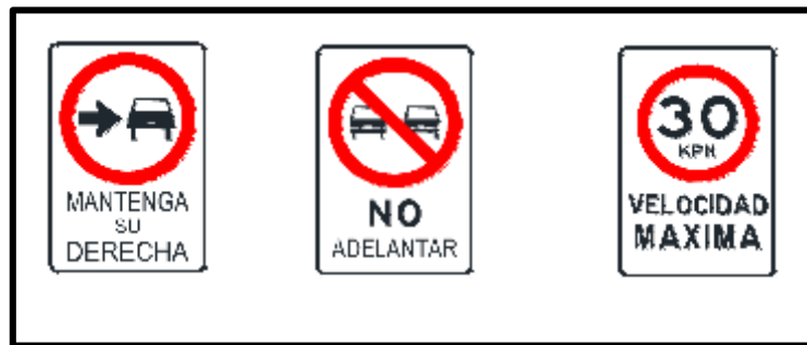
FIGURA N° 32: Señales Reglamentarias (R-15 R-16 R-30)
