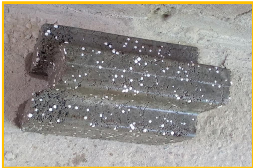
Figura 13: Bloques de anclaje de concreto y poliestireno
