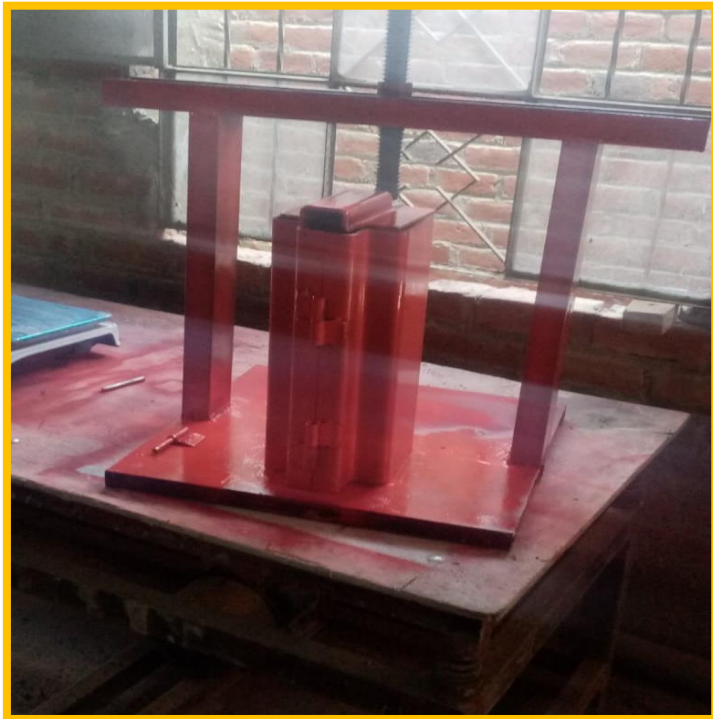
Figura 15: Molde y prensa para fabricación de bloque de anclaje
