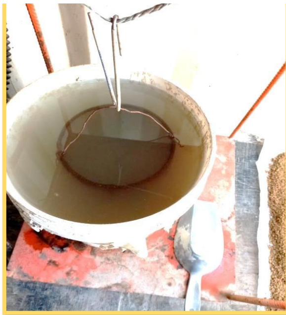
Figura 8: Muestra de agregado fino sumergido en agua (prueba de absorción)
