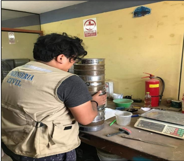
FOTO N° 12: SE OBSERVA EL TAMIZADO DE LA MUESTRA
