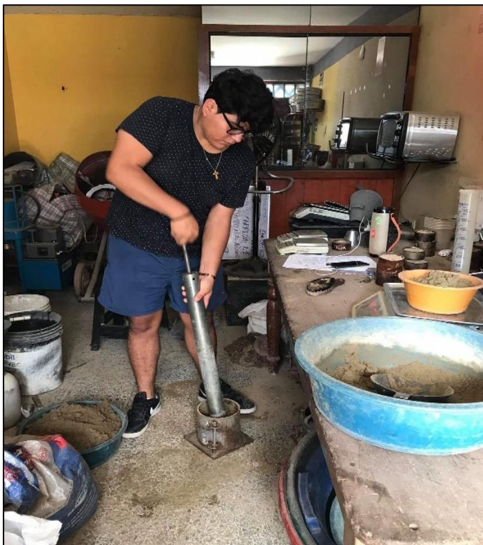
FOTO N° 15: SE OBSERVA EL COMPACTADO DE LA MUESTRA POR CAPAS, CADA CAPA CON 56 GOLPES EN EL MOLDE
