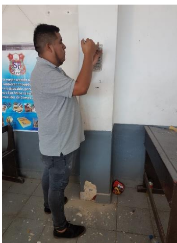
Figura 16: Realización de ensayo de Esclerómetro en el pabellón 3 – 1er piso
