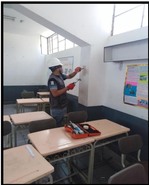
Figura 11: Realización de ensayo de Esclerómetro en columnas.
