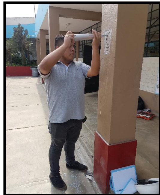
Figura 11: Realización de ensayo de Esclerómetro en columnas.
