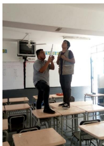
Figura 16: Realización de ensayo de Esclerómetro en el pabellón 3 – 1er piso
