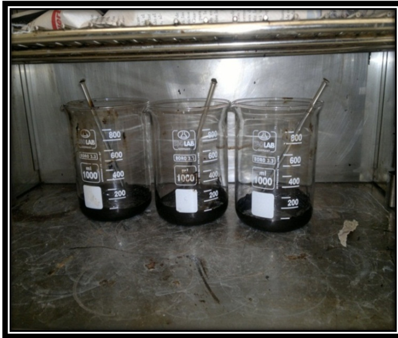
Fotografía N°07. Muestras en el horno a 163°C durante 3 horas.
