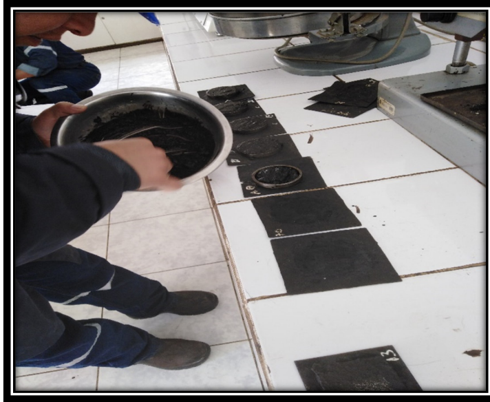
Fotografía n°29. Colocación de mezcla en moldes pequeños.
