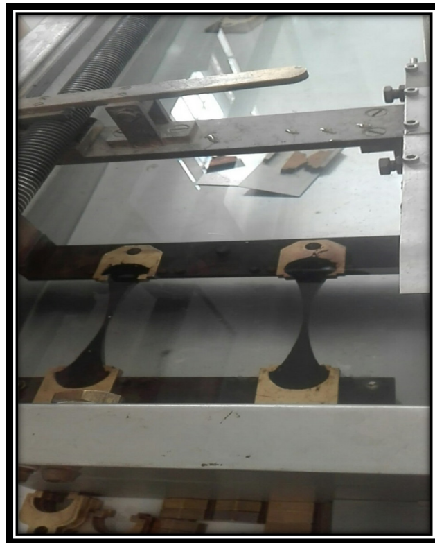
Fotografía n°22. Elongación de residuo asfáltico.
