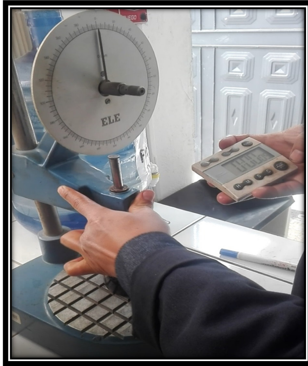
Fotografía n°18. Control de 5 segundos para ensayo de penetración.
