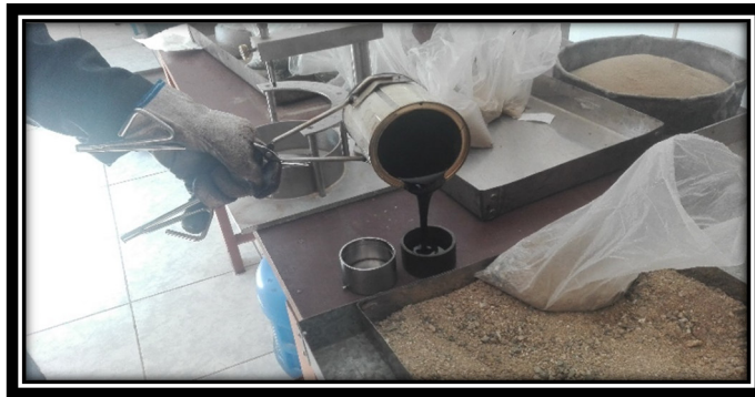
Fotografía n°17. Muestra con residuo asfáltico
