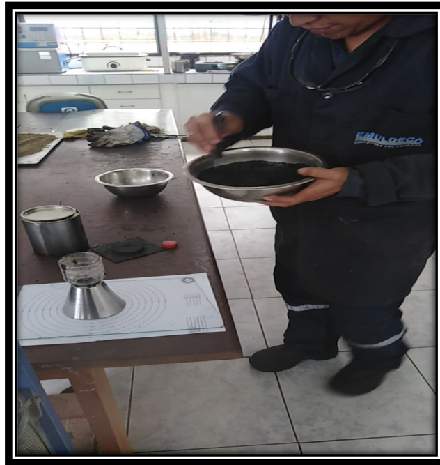
Fotografía n°26. Nivelación de Cono de Kansas.
