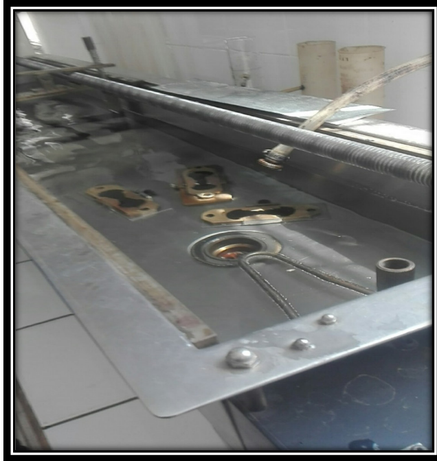
Fotografía n°21. Baño maría a 5°C para ensayo de ductilidad.
