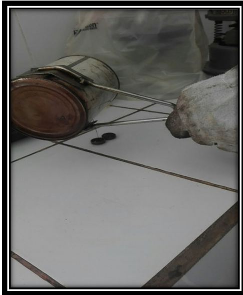
Fotografía N°13. Colocación de residuo asfáltico en anillos.
