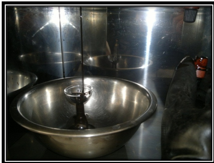
Fotografía N°09. Flujo de la emulsión a través del viscosímetro.
