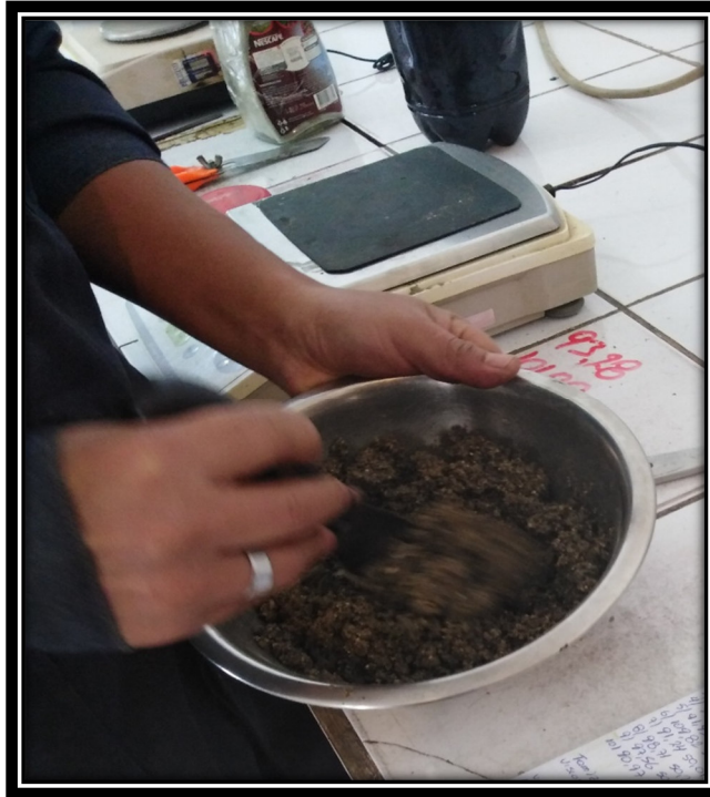
Fotografía n°27. Dosificación de mezcla asfáltica.
