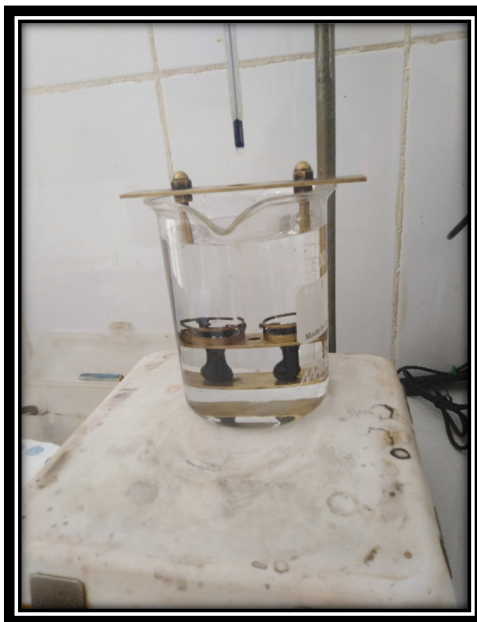
Fotografía N°15. Ablandamiento del bitumen.
