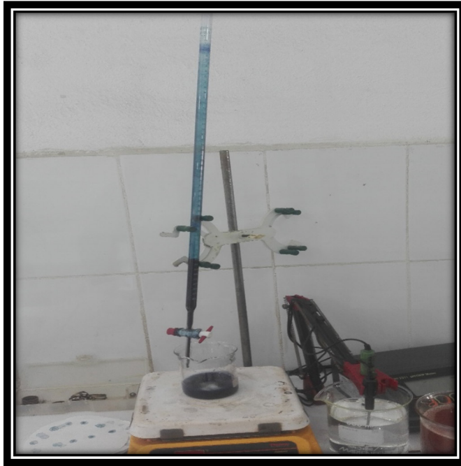
Fotografía N°05. Contenido de metileno.
