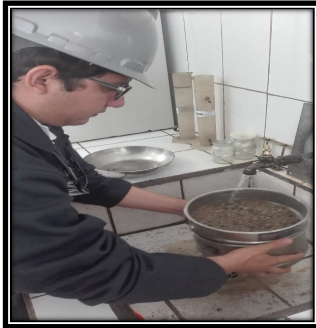
Fotografía N°01. Lavado de material mineral en tamiz #10 y #200. Ensayo de Granulometría
