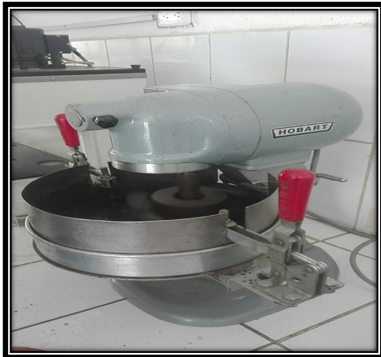
Fotografía n°32. Abrasión de espécimen.
