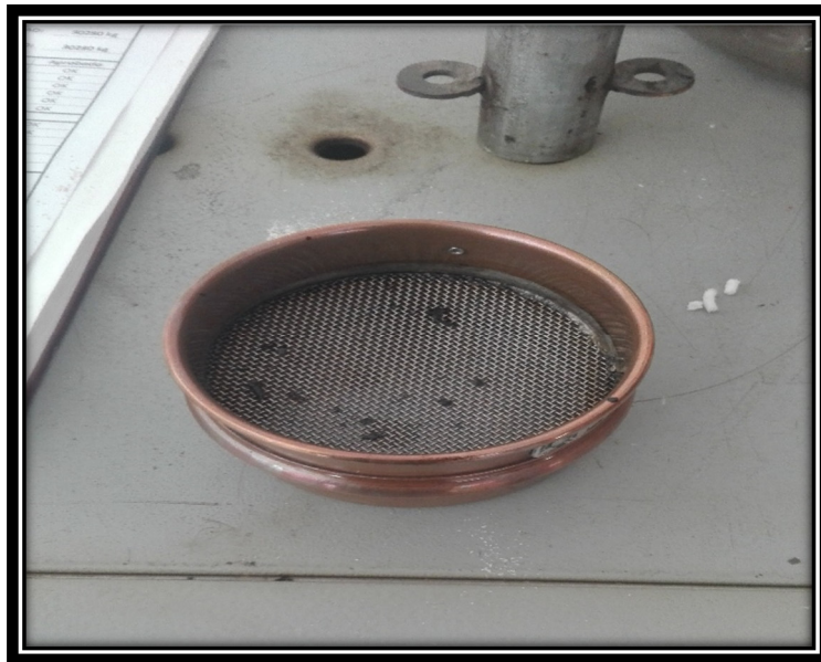
Fotografía N°10. Producto asfáltico mal emulsionado
