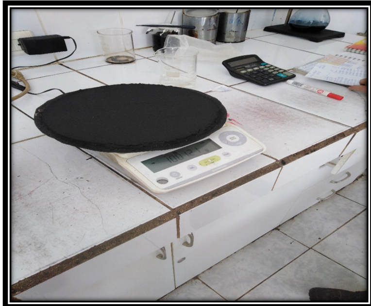
Fotografía n°31. Peso inicial de pastilla para ensayo de cohesión.
