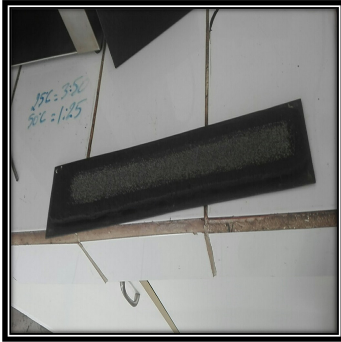
Fotografía n°33. Especimen después de 1000 ciclos del ensayo rueda cargada.
