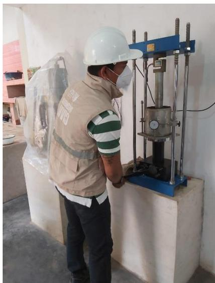
**Imagen N° 9: Realizando ensayo de proctor**
