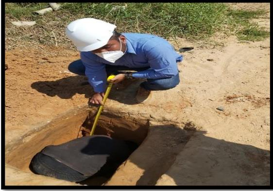
**Imagen N° 1:** Excavación de Calicata
