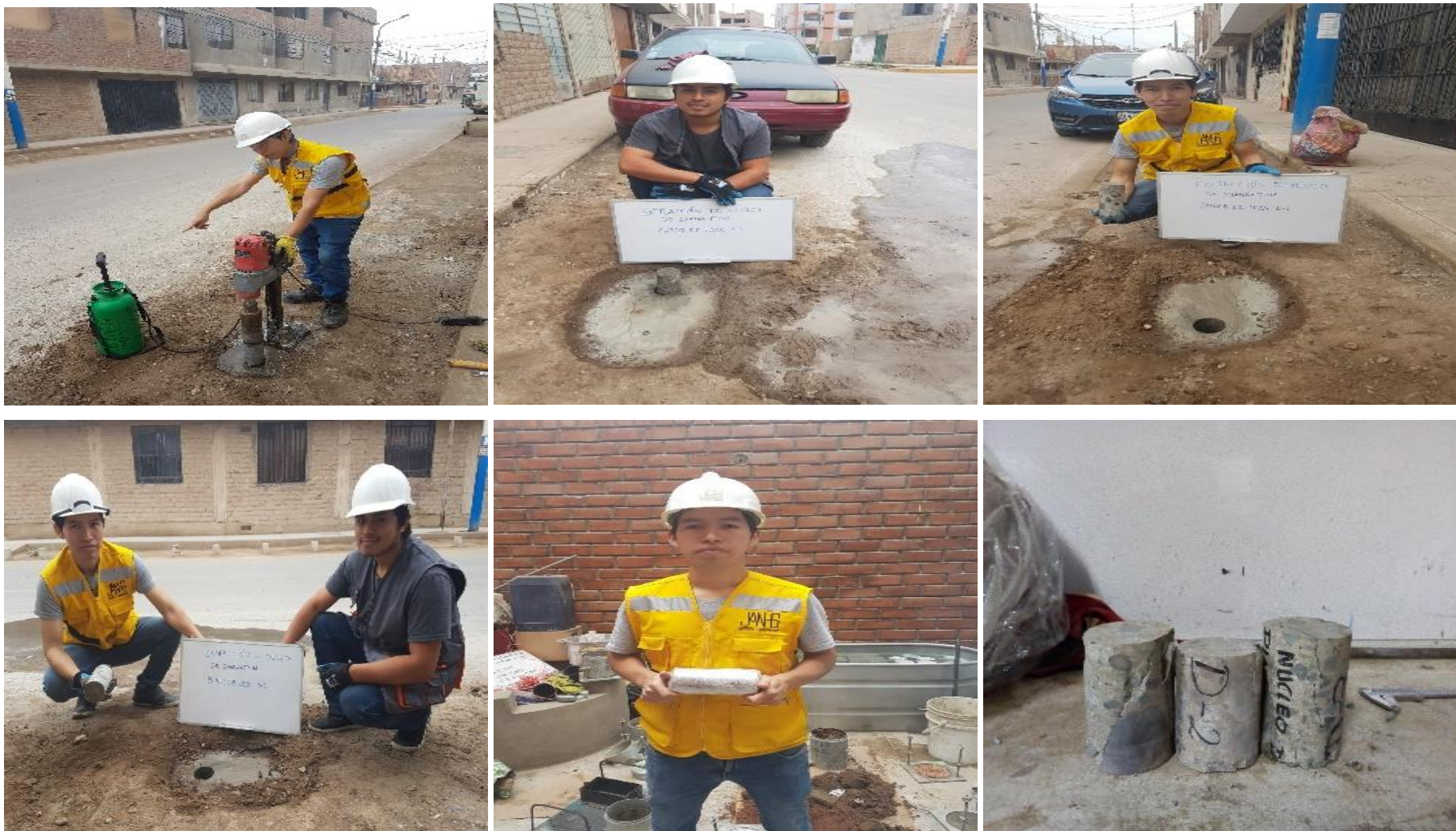
Panel fotográfico 21. Toma de núcleos y vigas en concreto endurecido según la Normativa MTC E 707, NTP.39.059, ASTM C 42, AASHTO T 24
