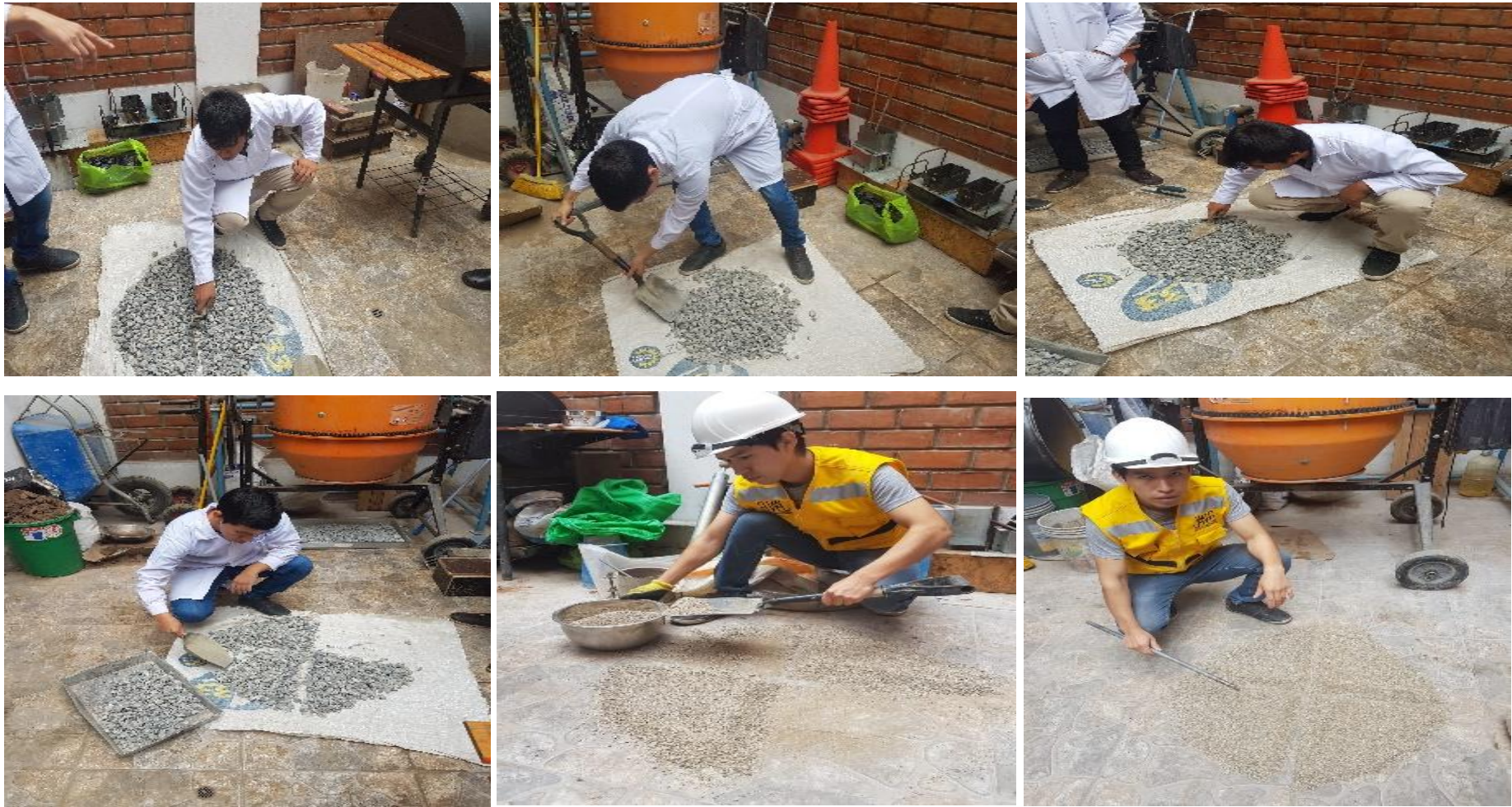
Panel fotográfico 11. Obtención de muestras representativas según la Normativa del MTC E 105 y la NTP 339.089
