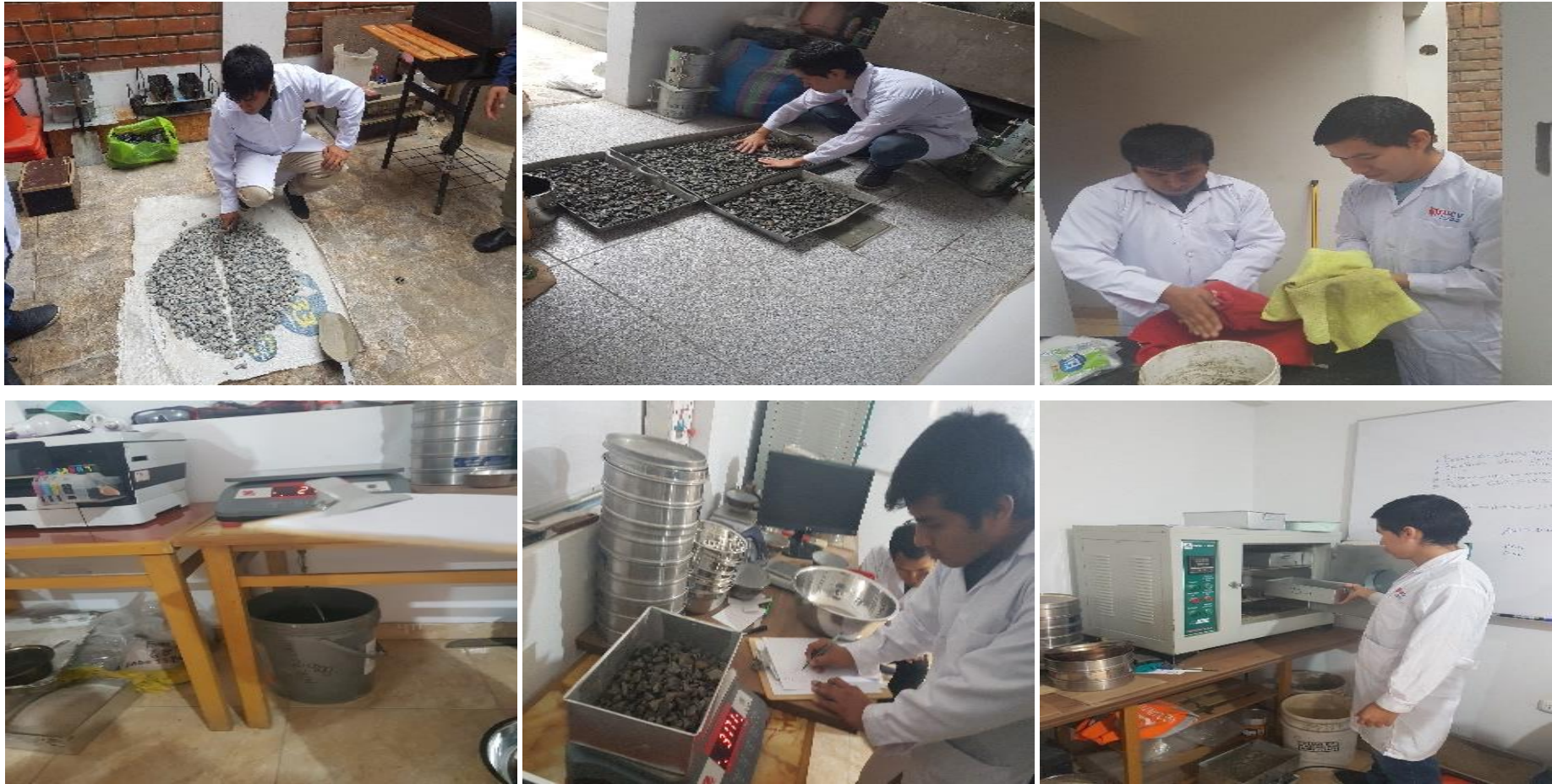
Panel fotográfico 19. Gravedad específica y absorción de agregado grueso según la Normativa MTC E 206, NTP 400.021.
