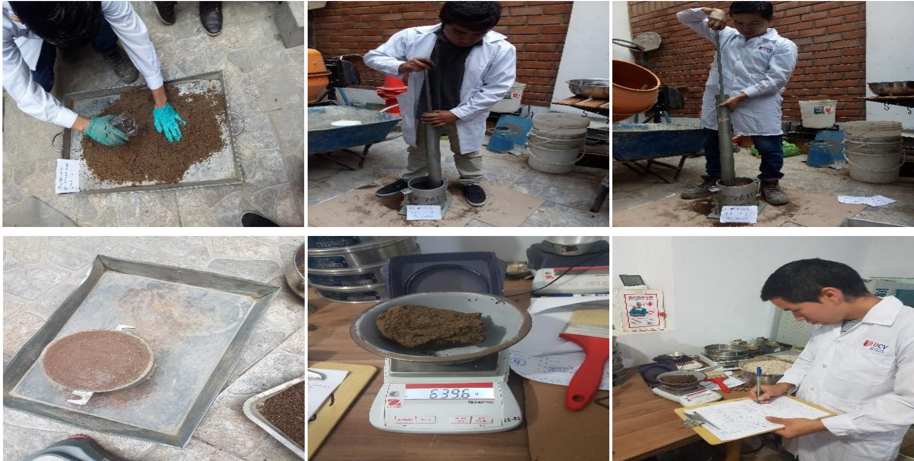
Panel fotográfico 22. Compactación de suelos utilizando Proctor modificado según la Normativa NTP 339.141, ASTM D 1557
