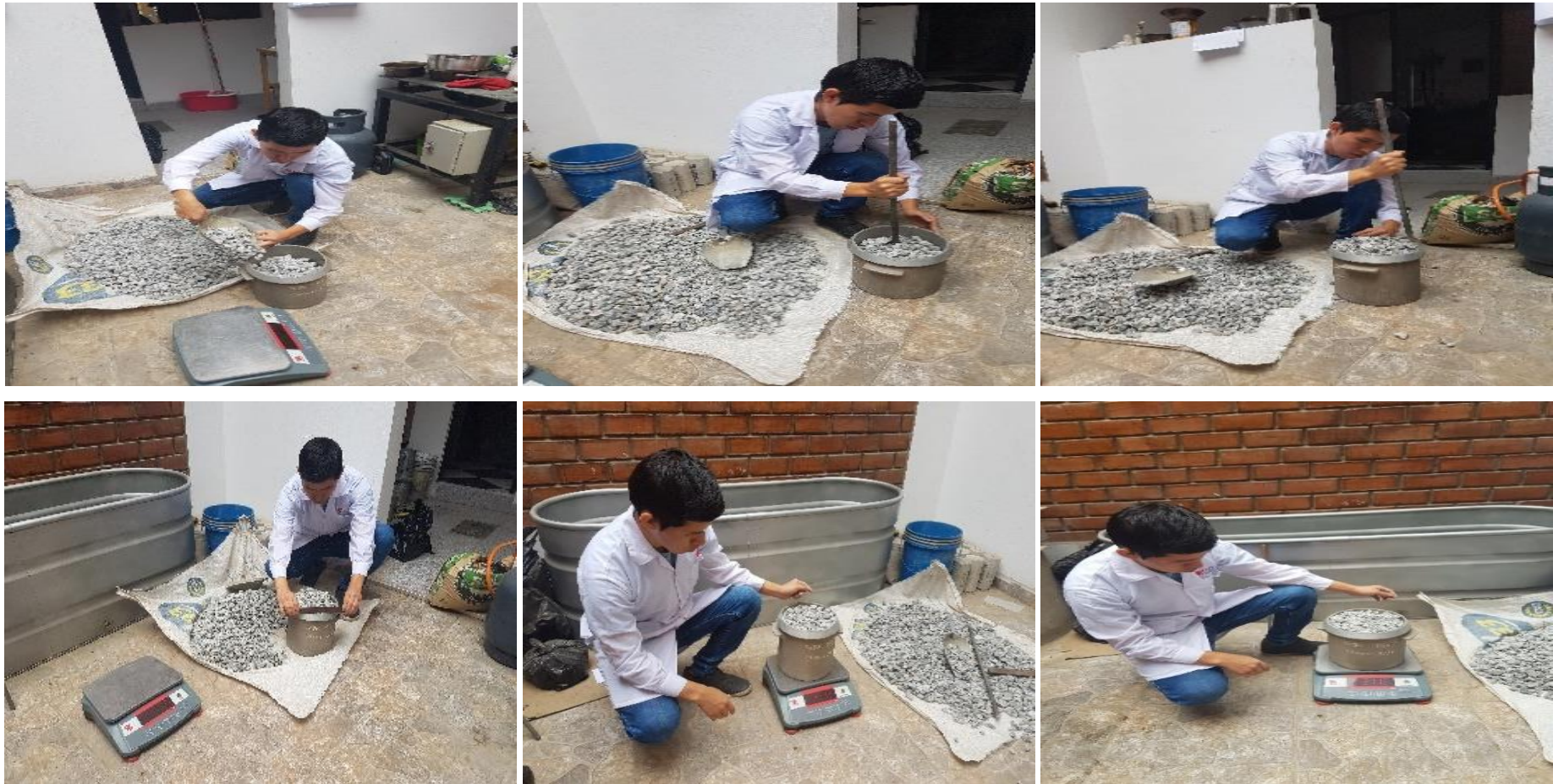
Panel fotográfico 13. Obtención de peso unitario y vacíos del agregado grueso reciclado según la Normativa del MTC E 203, NTP 200.17
