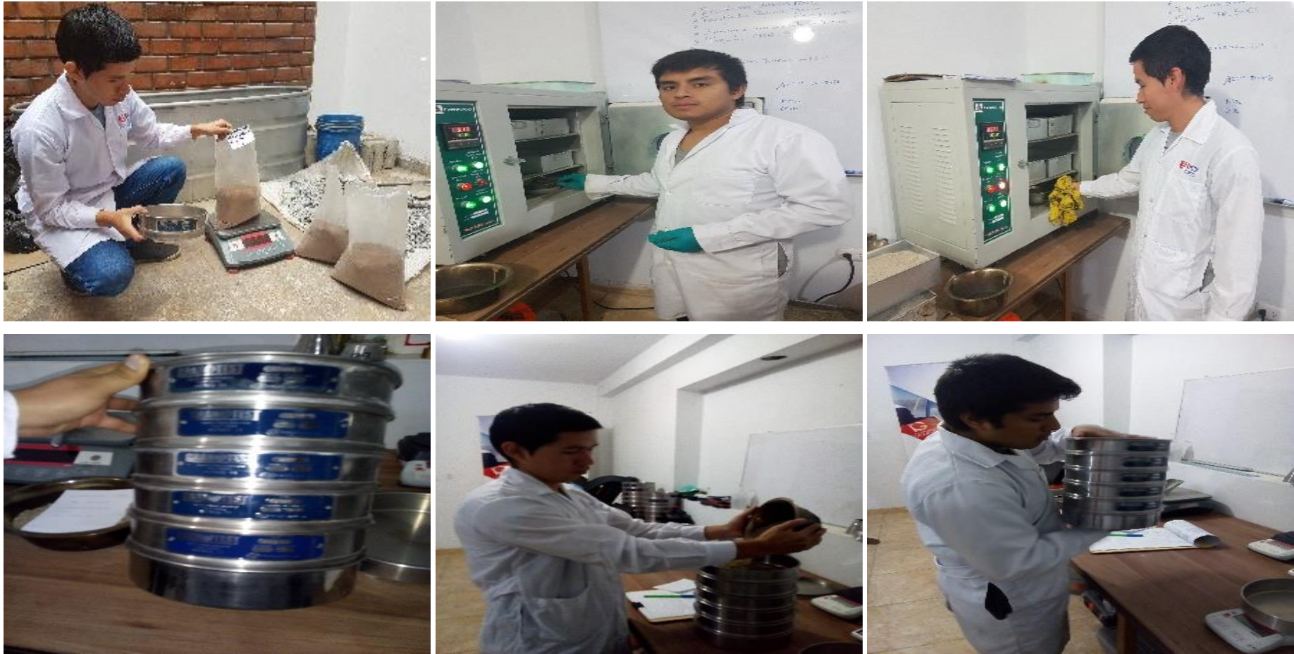
Panel fotográfico 23. Análisis granulométrico de suelos por tamizado según la Normativa MTC E 107, ASTM D 422
