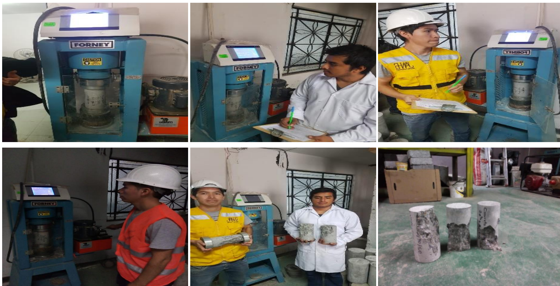
Panel fotográfico 27. Resistencia a la compresión de testigos cilíndricos según la Normativa NTP 339.04 ASTM C- 39 – 39M- 2005e2
