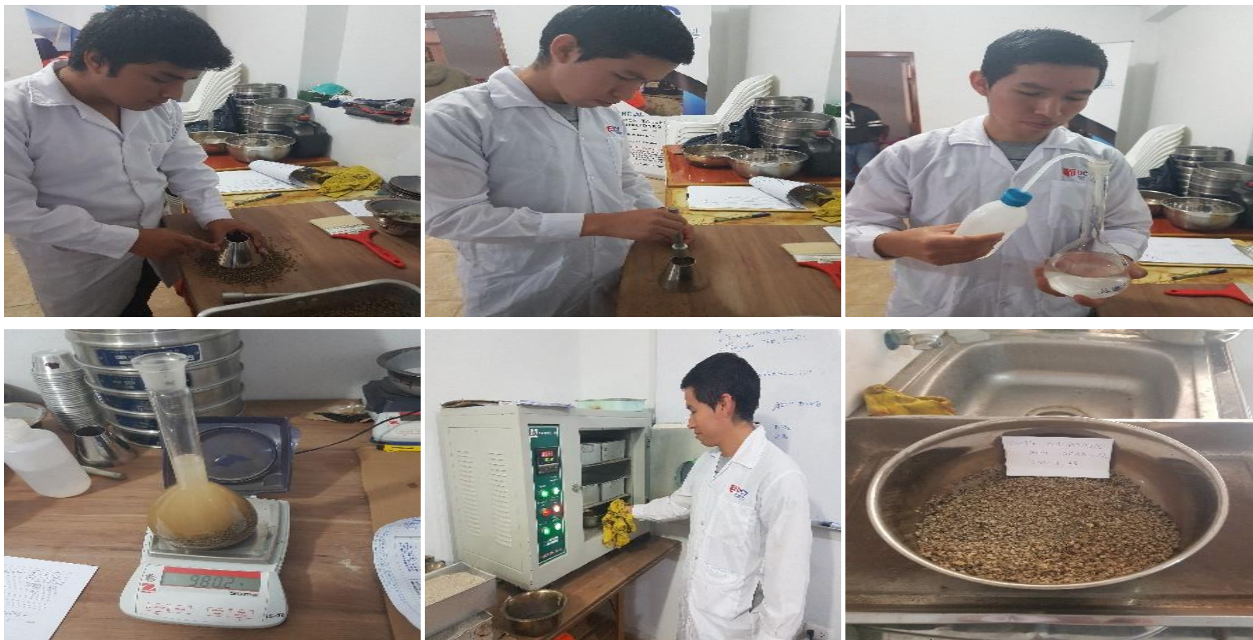
Panel fotográfico 18. Gravedad específica y absorción de agregado fino según la Normativa MTC 205, NTP 400.22.
