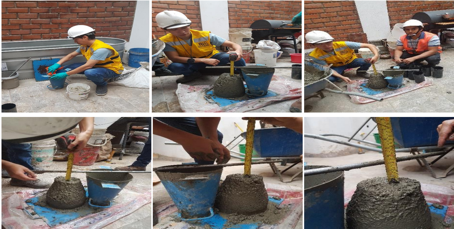
Panel fotográfico 25. Slump de concreto según la Normativa NTP 339.035, AASHTO T 119, ASTM T
