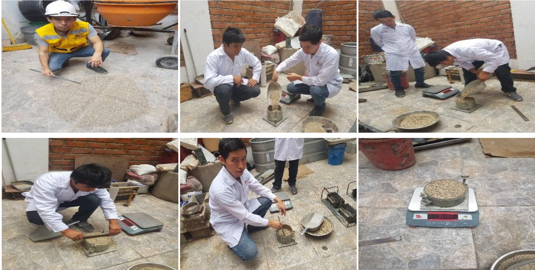
Panel fotográfico 14. Obtención de peso unitario y vacíos del agregado fino según la Normativa del MTC E 203, NTP 200.17
