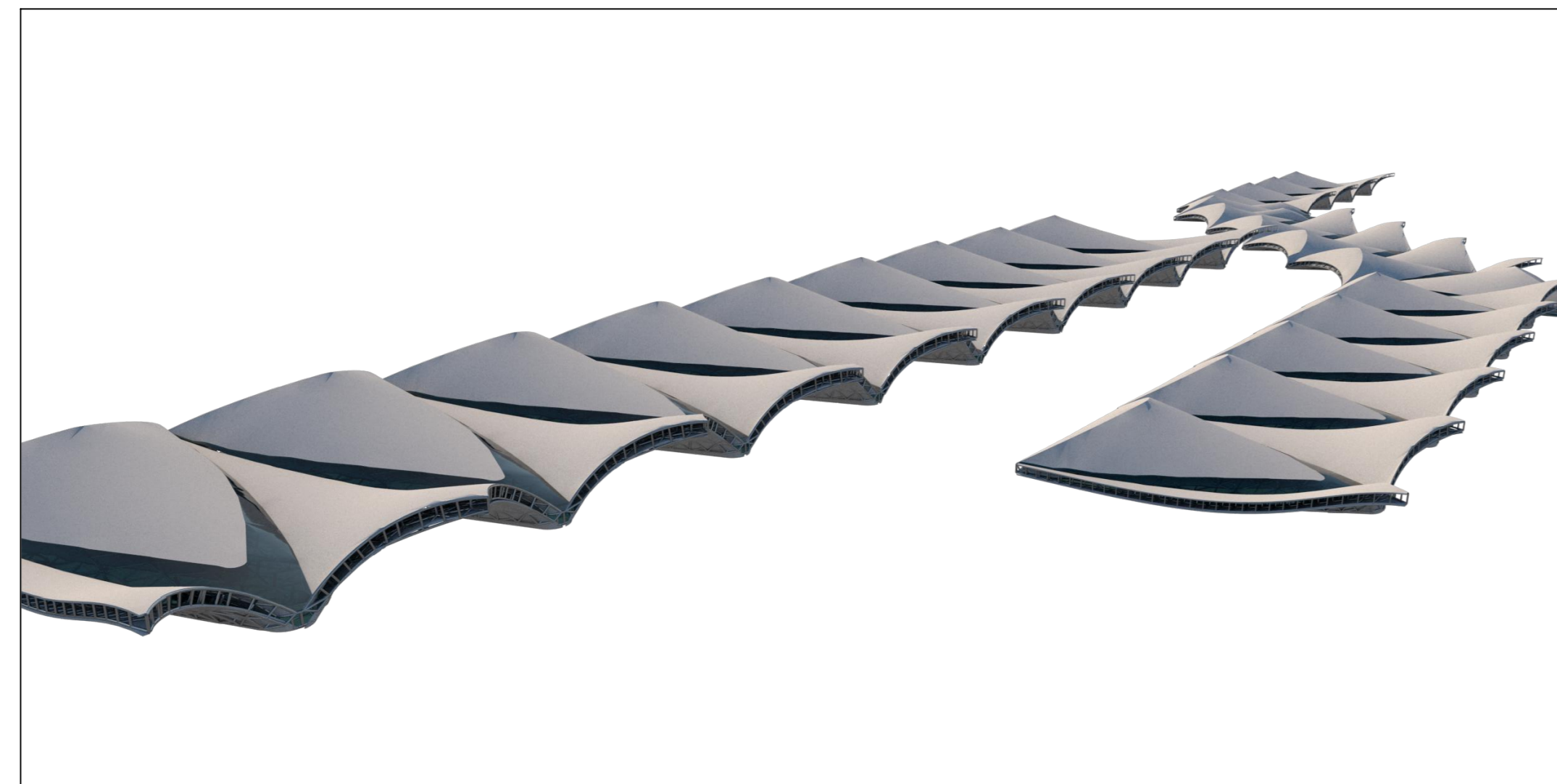
15 DC-15 ISOMÉTRICO DE LA COBERTURA CON EL PANEL CURVO SALA DE EMBARQUE 1/5
