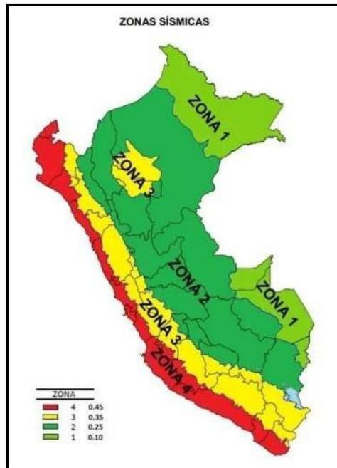
Figura 1: Factor de zonificación sísmica
