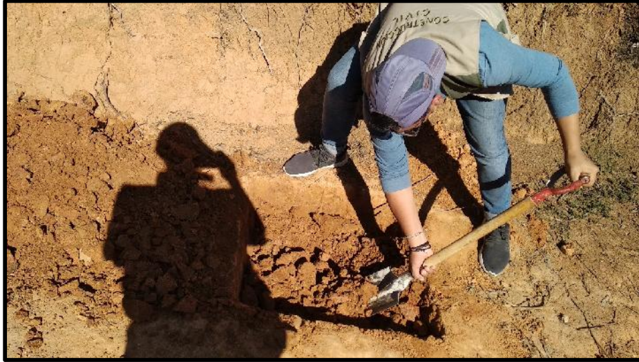
FOTO 09: Excavación de calicatas para el estudio de suelo
