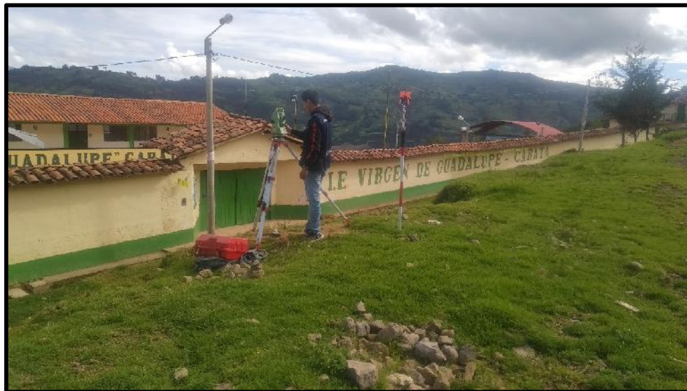
FOTO 06: Punto inicial para el levantamiento topográfico de la carretera Otuzco – Caserío Carata.
