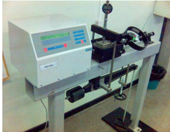
Figura 8 Ensayo para obtener los parámetros de resistencia de la muestra
