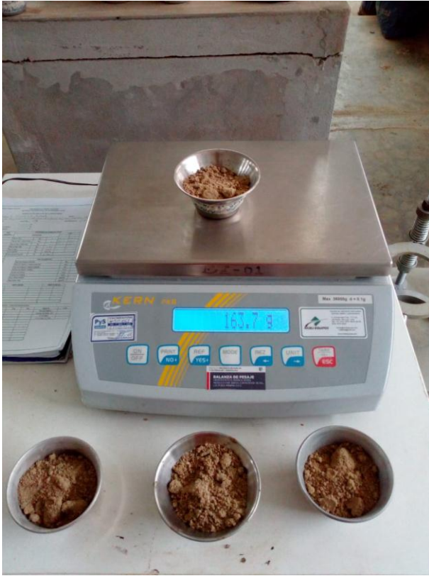
Foto N° 7 Pesado de muestras de suelo en laboratorio de mecánica de suelos de la Universidad Cesar Vallejo – filial Chiclayo
