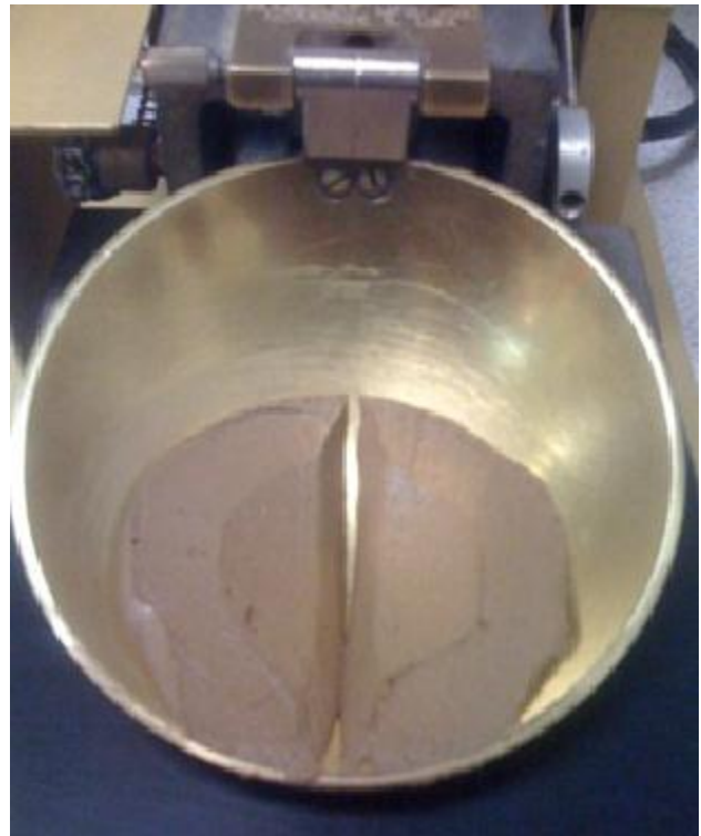
Foto N° 8 Ensayo para determinar los índices de Atterberg
