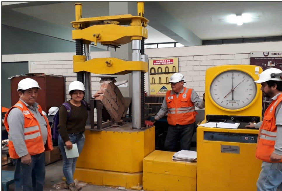
Figura 25. Ensayo de compresión diagonal en muretes
