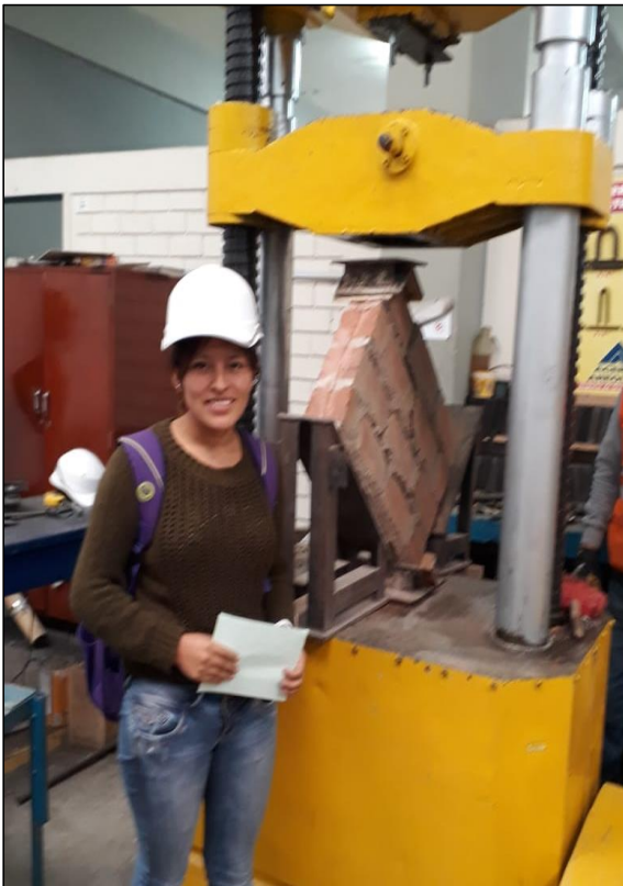
Fotografía 8. Ensayo de compresión a corte diagonal de murete
