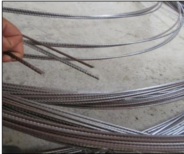
Figura 53. Varilla de acero de diámetro 4.7mm
