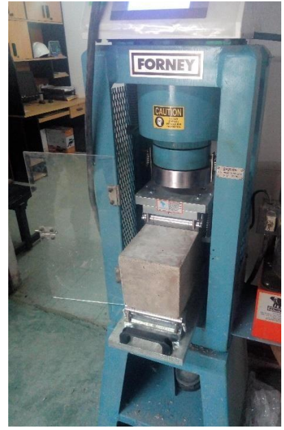
figura 8. Ensayo a tracción de vigas
