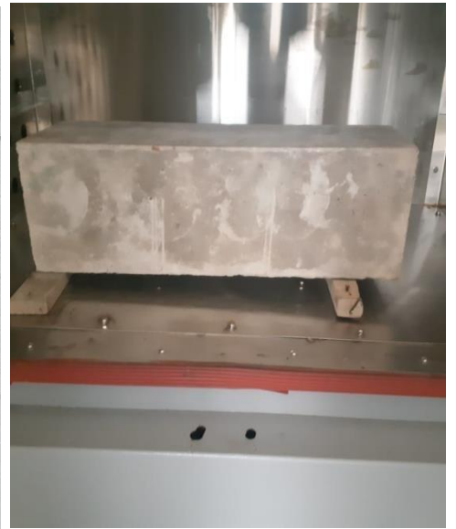
figura 11. Viga en el horno
