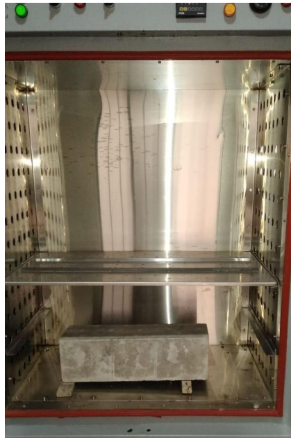
figura 7. Exposición a temperatura de vigas
