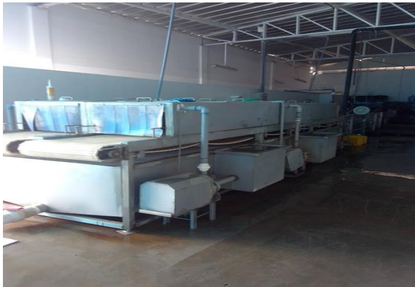
Figura 27: Proceso de lavado y desinfección de materia prima Fuente: Servicios e Inversiones Nathanael S.A.C.
