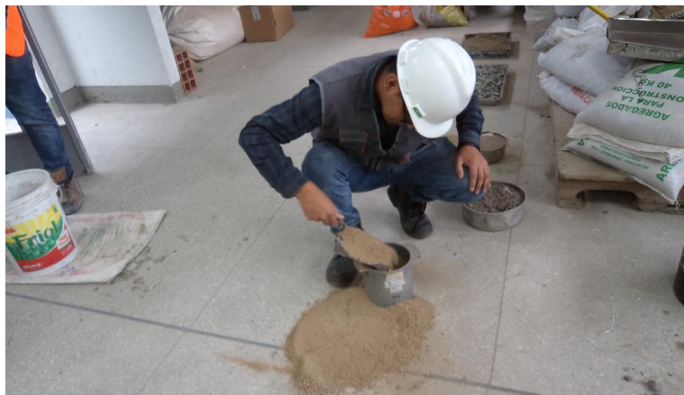
Imagen 2: cuarteo del material (arena gruesa)
