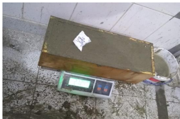
Figura 18: Peso de vigueta
