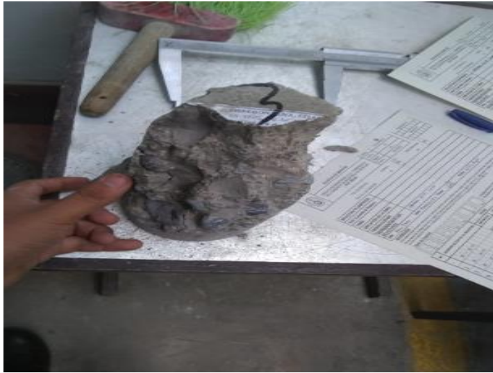
Imagen 24: Clases 3 de rotura
