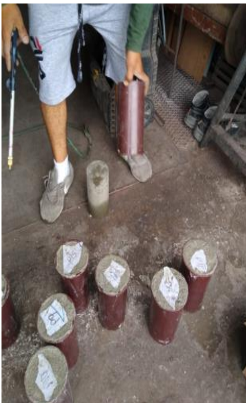
Figura 20: Desencofrado de probetas
