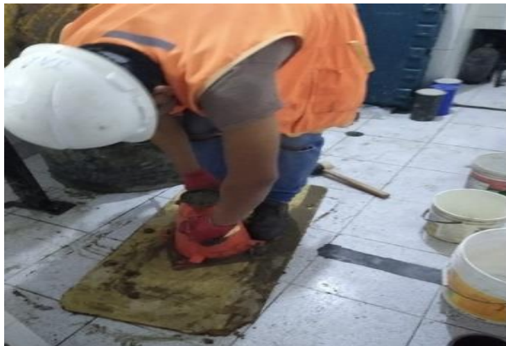
Imagen 17: Prueba de SLUMP
