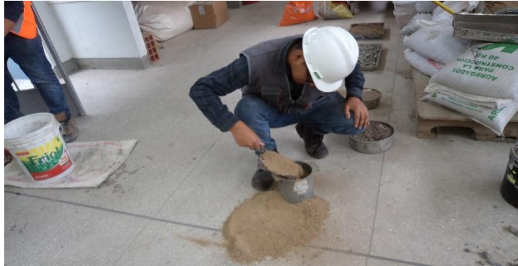
Figura 10: Realización de estudio granulométrico.
