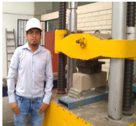
Figura 24: Rotura de viguetas
