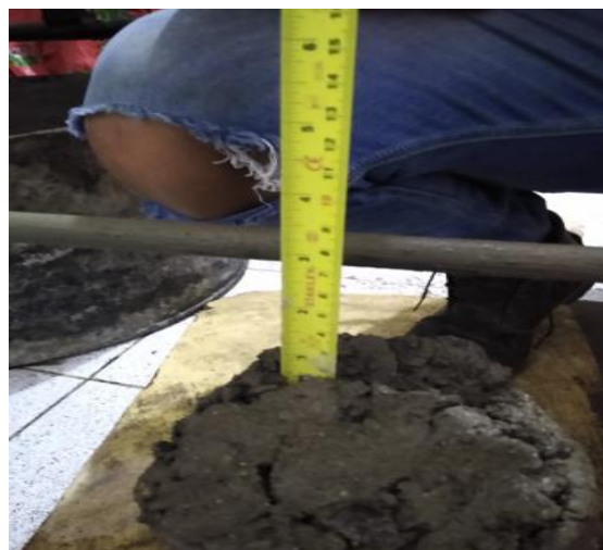
Figura 14: Prueba de slump.
