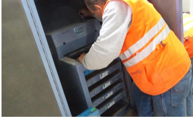
Imagen 7: Paso por tamiz de piedra chancada de diferentes tamaños.
