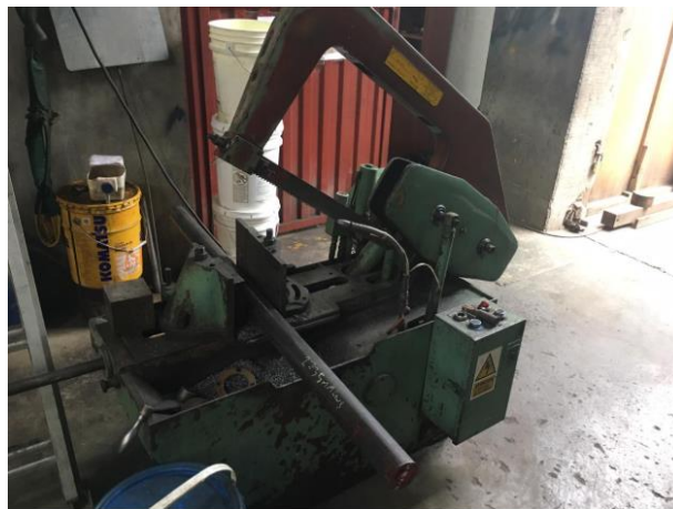
figura 3: sierra alternativa para el corte de barras de acero
