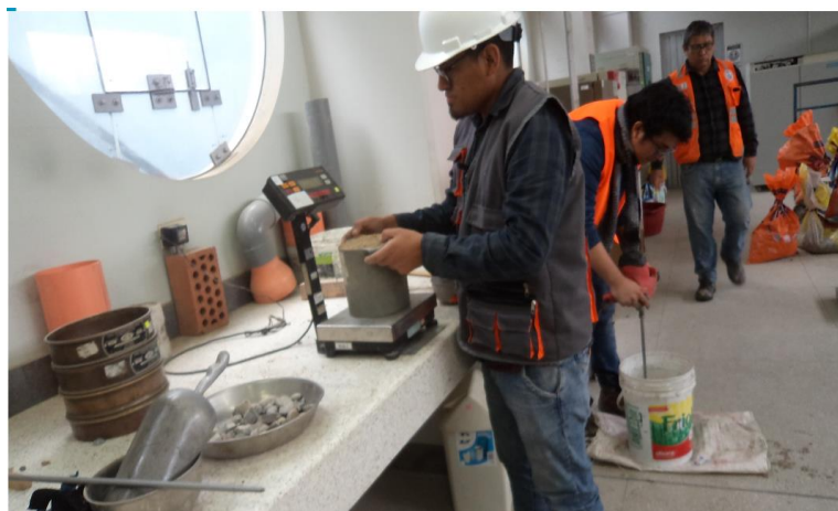
Imagen 2: cuarteo del material (arena gruesa)
