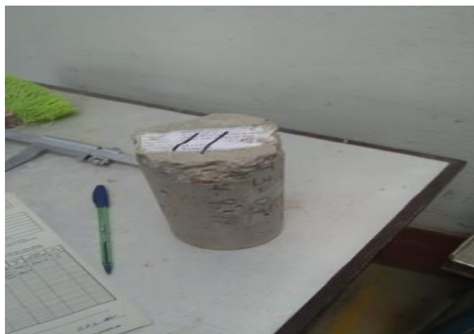
Imagen 26: Clases 1 de rotura
