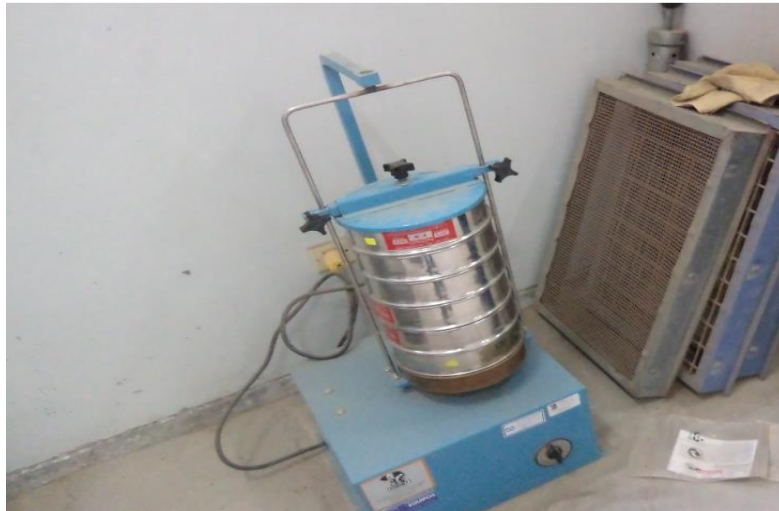
Imagen 4: Paso por tamiz, de diferente tamaños
