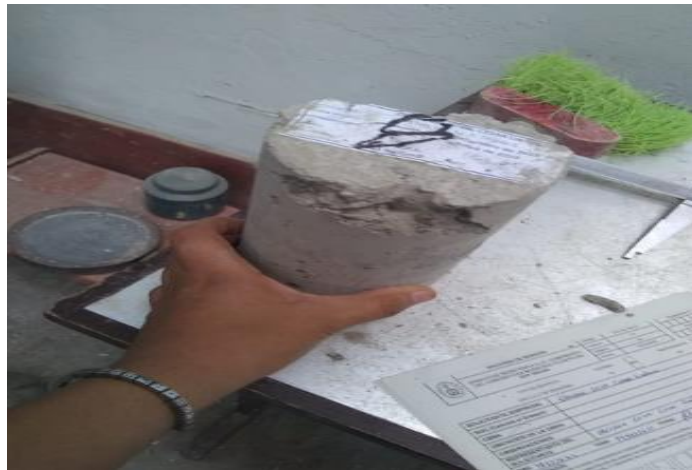
Imagen 25: Clases 2 de rotura
