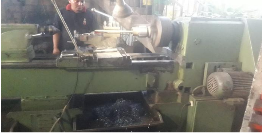
Figura 3: Equipo para la obtención de la fibra de acero.
