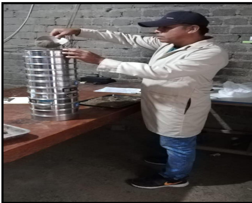
IMAGEN N°8: Ensayo de granulometría
