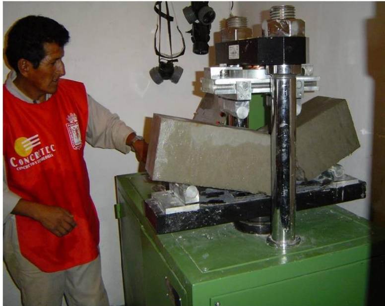
Figura 5.3. Ensayo de tracción por flexión (módulo de rotura)
