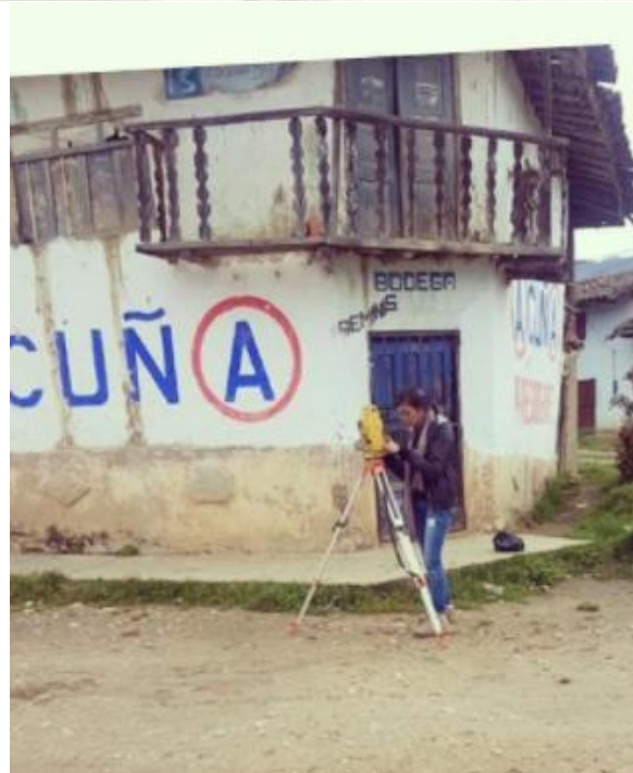
Fotografías: Levantamiento topográfico usando estación total
