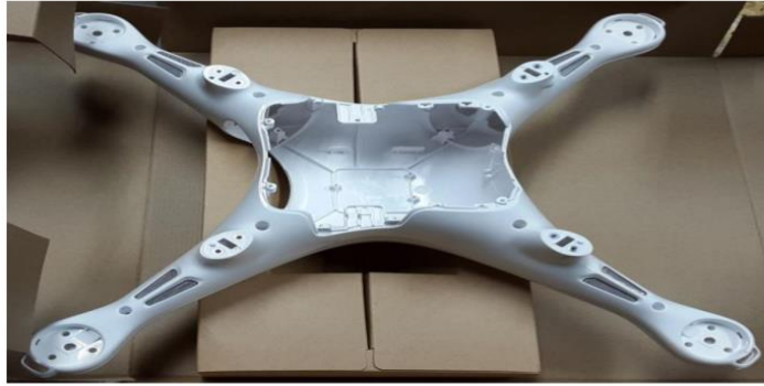
Figura 16: Estructura de VANT Multirotor
