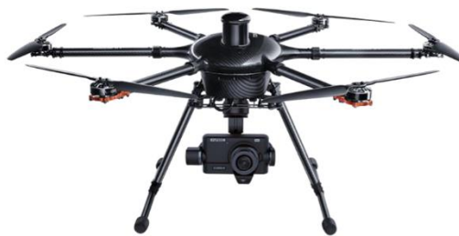
Figura 13: Vehículo Aéreo no Tripulado modelo Yunecc H920-CG04 Multirotor
