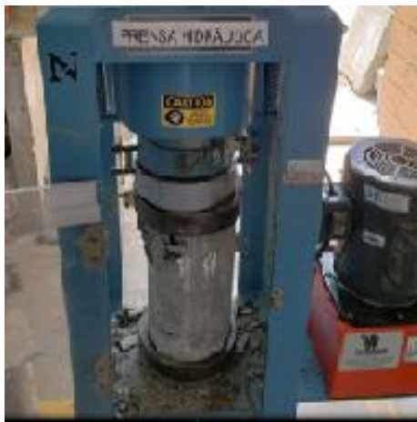
Imagen 4. Rotura de especímenes cilíndricos a compresión
