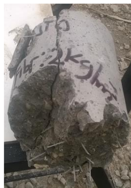
Imagen 9. Rotura del espécimen mediante los ensayos de compresion, flexion y tracción con la adición de fibra SIKAFIBER FORCE PP – 48.
