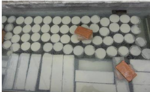
Imagen 4. Curado de los especímenes para los ensayos en estado endurecido
