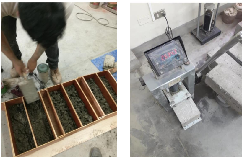
Figura 25. Elaboración de vigueta con la fibra sintética para el ensayo de flexión.
