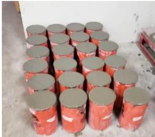
Imagen 1. Llenado y vibrado de los especímenes.
