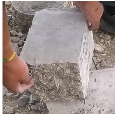
Imagen 9. Rotura del espécimen mediante los ensayos de compresion, flexion y tracción con la adición de fibra SIKAFIBER FORCE PP – 48.
