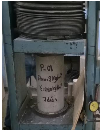
Imagen 6. Ensayo de compresión de la probeta cilíndrica
