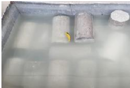
Imagen 2. Curado de los especímenes de probeta cilíndrica y viga.
