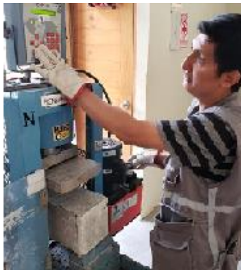
Imagen 6. Rotura de vigas con el apoyo del jefe de laboratorio
