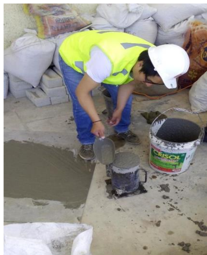
Imagen 3. Elaboración de los especímenes para los ensayos
