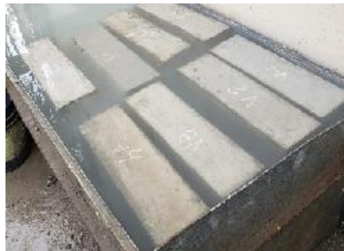
Imagen 2. Curado de los especímenes de probeta cilíndrica y viga.
