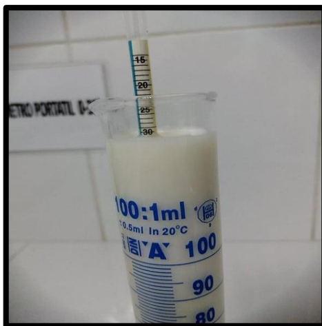
Ilustración 11: medición de la densidad
