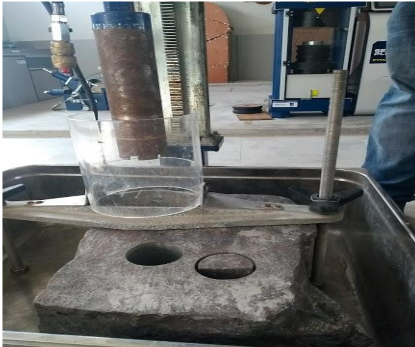
Broca perforadora, el material fue traído de la cantera Tuna Blanca (roca caliza)
