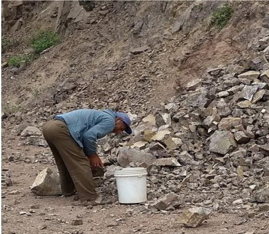
El material es cargado en baldes hacia chancadora
