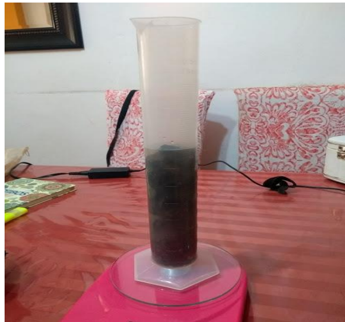
Muestra del material en el tubo de ensayo, a través de ello se determinó la porosidad del material
