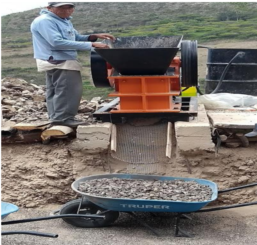
El material es tratado en la chancadora, se obtiene ripio de ½ y confitillo
