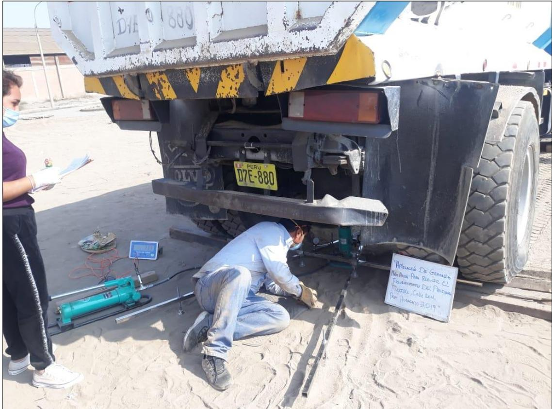
Registro de datos de carga y deformación en el terreno compactado con la adición de "Geomallas Multiaxiales"
