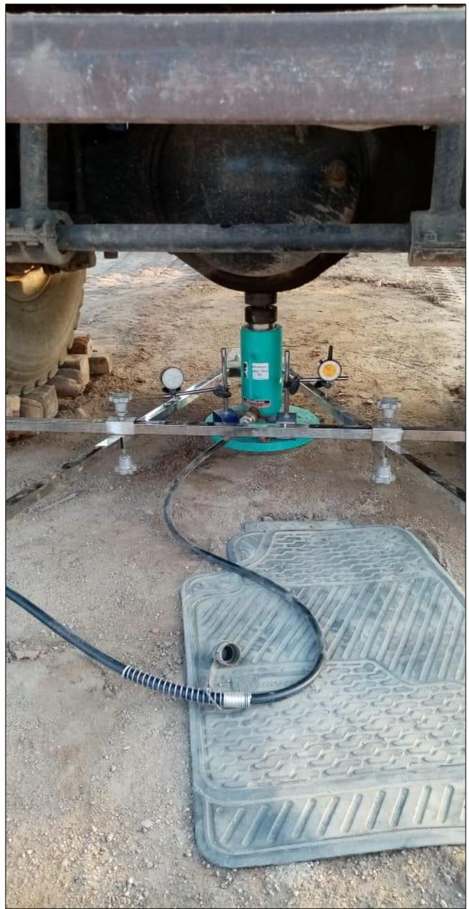
Ensamblaje del equipo de placa de carga estática en terreno compactado con la adición de "Geomallas Multiaxiales"
