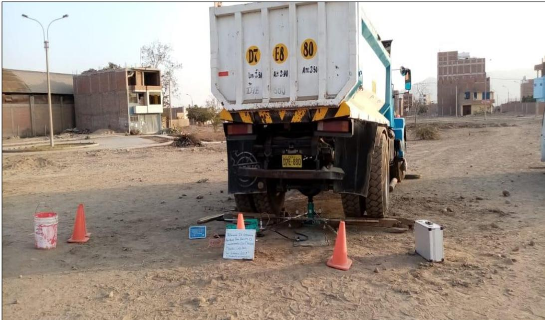
Ensamblaje del equipo de placa de carga estática
