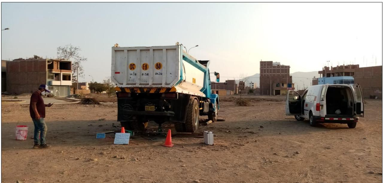
Finalización del ensayo de carga de placa estática
