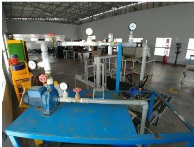
Fotografía 1: módulo de pruebas de Bombas Centrifugas
