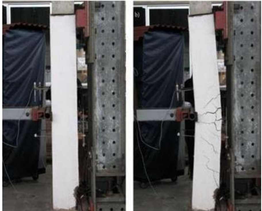
ENSAYO DE FLEXIÓN DEL MURO.
