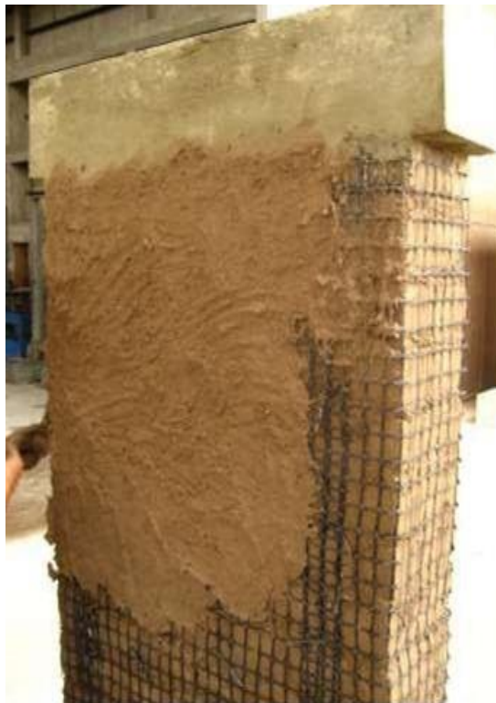
PRUEBA DE GEOMALLA CON MURO DE ADOBE
