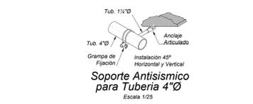
Detalle Soporte Antisismico para Tuberia 4"O
