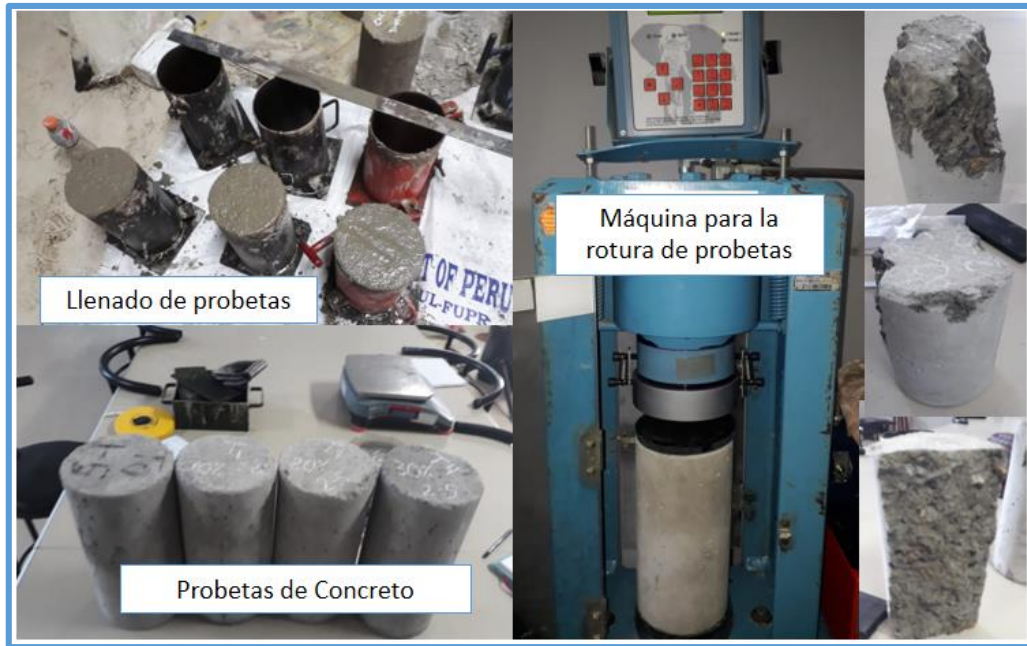
Figura 106. Resistencia a la compresión
