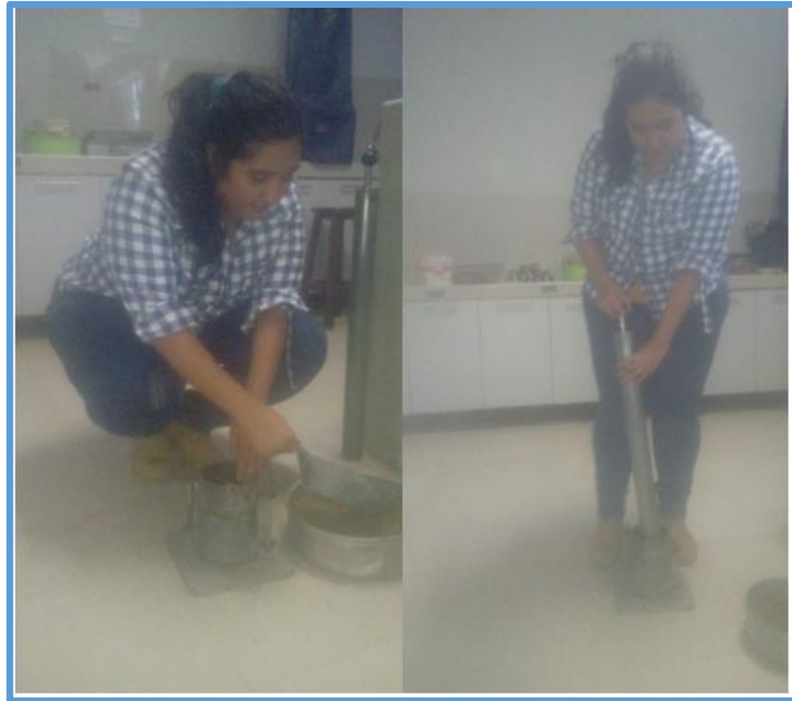
Figura 102. Ensayo proctor para estudio de suelos Fuente: Elaboración propia, 2019.
