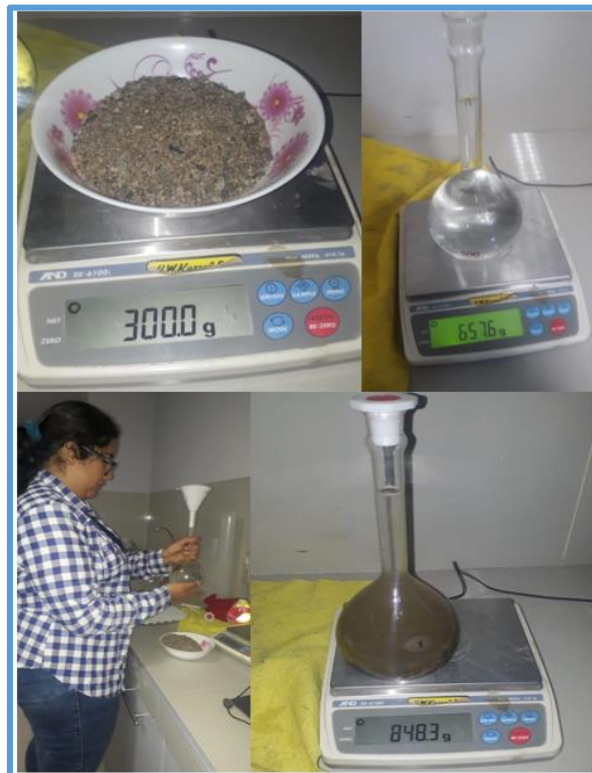
Figura 103. Ensayo de peso específico del agregado fino Fuente: Elaboración propia, 2019.
