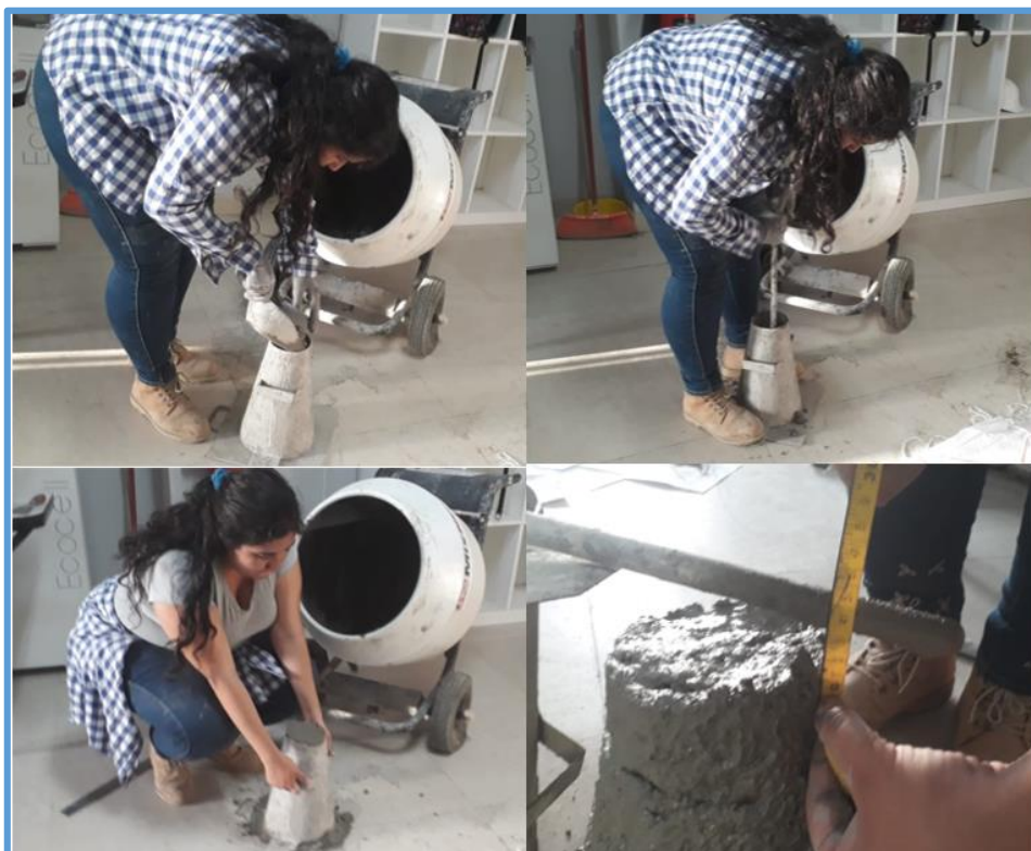
Figura 105. Asentamiento del concreto mediante el cono de Abrahams
