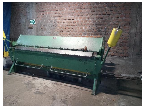
Figura 39: Máquina dobladora post test
