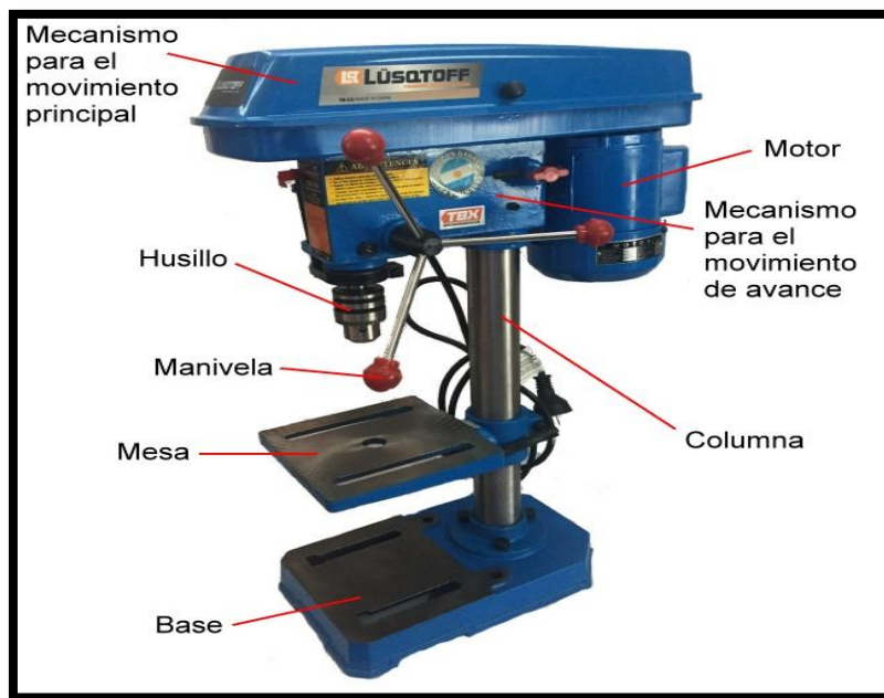
Figura N°2: Taladro de Columna
